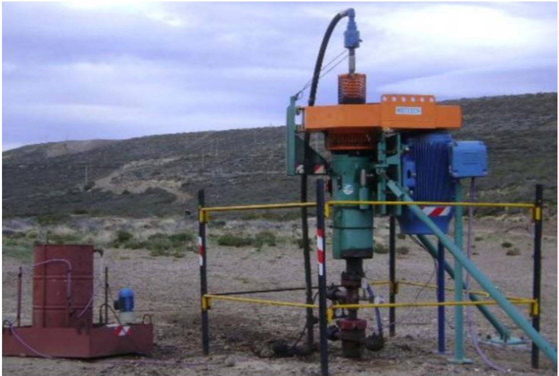
Figura 11. Cabezal PCP del sistema de trasmisión lubricada.
