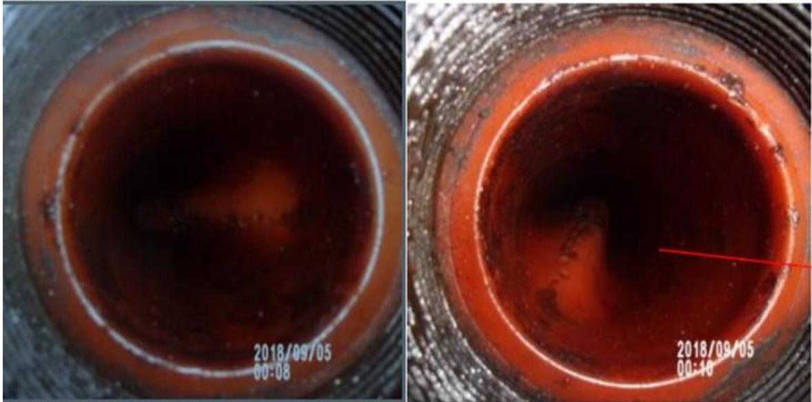
Figura 31. Falla de polímero interno de lined tubing, pozo Vel-311.
