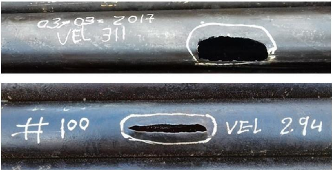
Figura 18. Tubería rota por rozamiento en los pozos Vel-311 y Vel-294.
