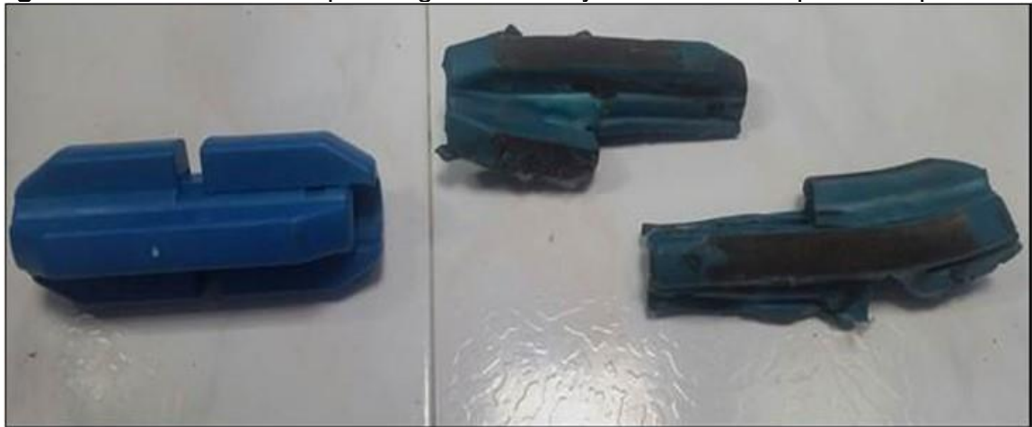
Figura 24. Centralizador tipo rod guide nuevo y fallado en Campo Velásquez.
