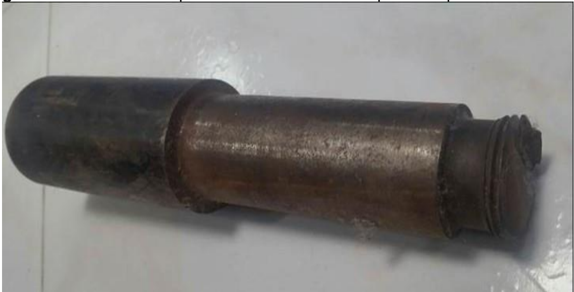
Figura 22. Centralizador tipo roto bear fallado en campo Velásquez.
