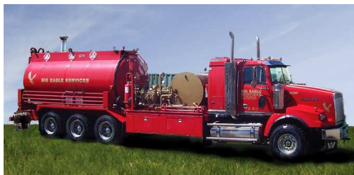
Figura 7. Camión de Inyección de químicos.
