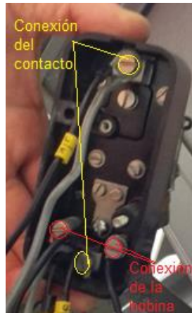
Figura 45. Conexiones del interruptor de alta tensión
