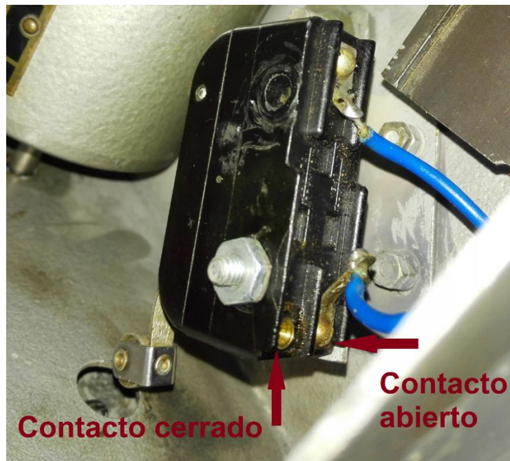
Figura 43. Microswitch conectado correctamente
