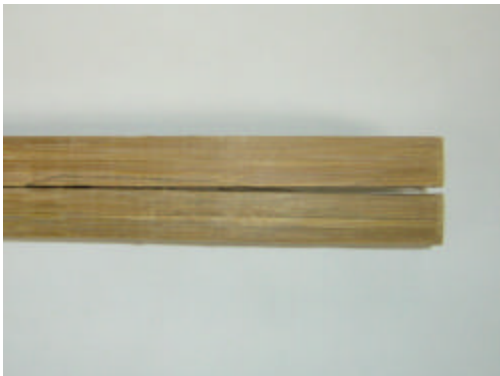
Fotografía 17. Falla a cortante en PFH
