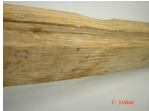
Fotografía 18. Falla en la guadua en PFH
