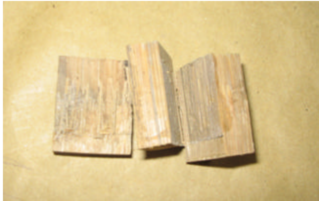
Fotografía 9. Falla por cortante en adhesivo
