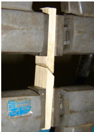
Fotografía 10. Falla por tracción en adhesivo
