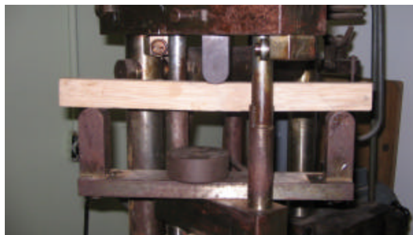
Fotografía 8. Ensayo de Flexión.
