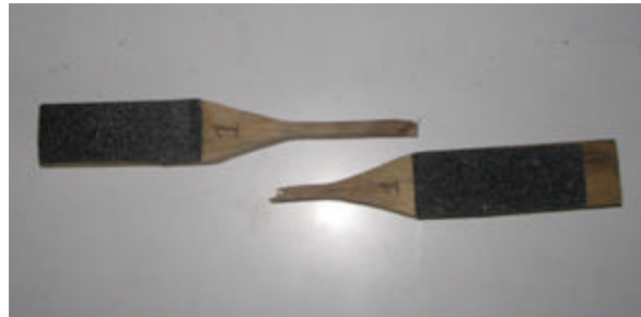
Fotografía 15. Falla por tracción
