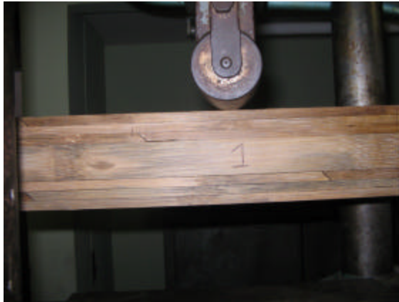
Fotografía 25. Viga Cargada en la mitad de la luz
