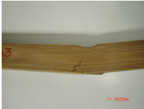
Fotografía 16. Falla en flexión laminado vertical
