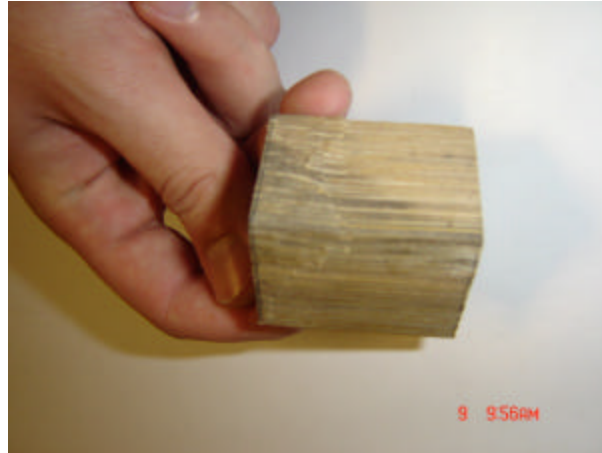
Fotografía 11. Falla Tipo en Compresión paralela
