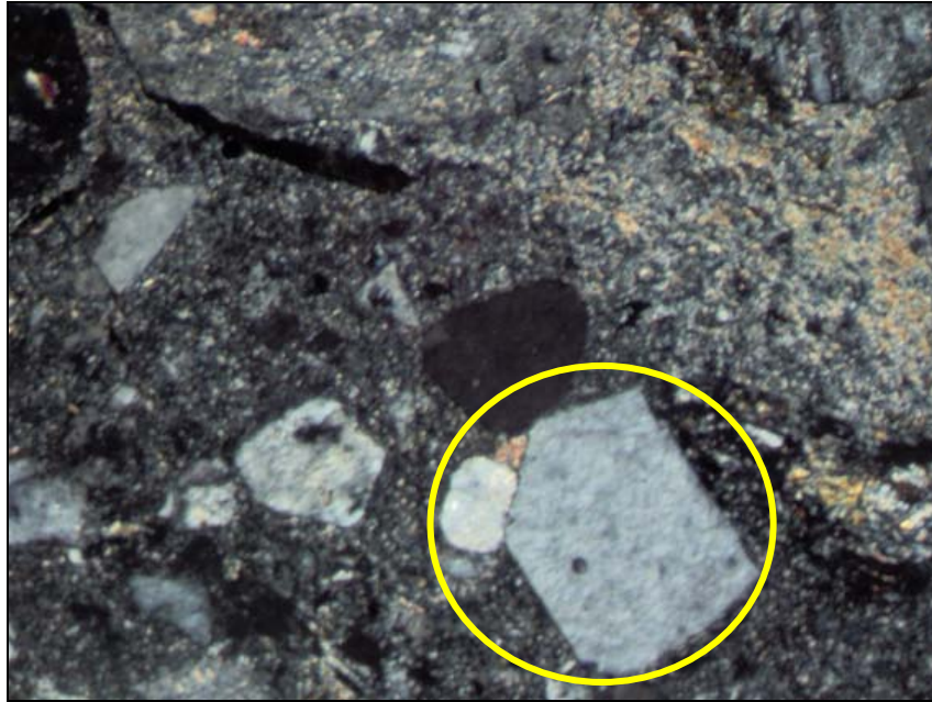
FIGURA 55. Sección delgada de la muestra JC85141-001. NC, aumento 10X. Intercrecimiento con borde de reacción entre un mineral de cuarzo (blanco de menor tamaño y a la izquierda) y una plagioclasa (gris y a la derecha).
