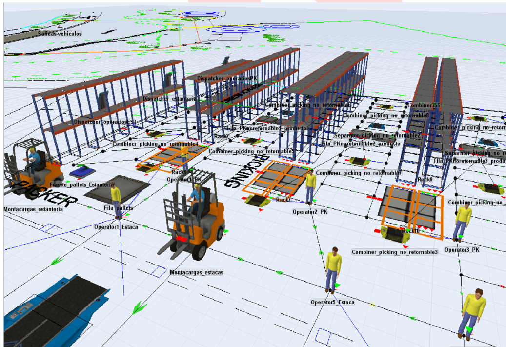
Ilustración 17. Simulación de la preparación de pedidos
