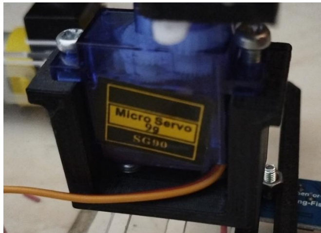
Figura 19 Soporte de servomotor en impresión 3D con servomotor montado.
