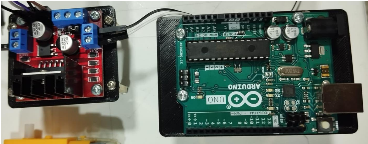
Figura 39 Montaje de Placa Arduino UNO y Motor driver L298N a soportes impresos.
