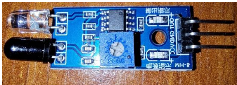
Figura 27 Sensor infrarrojo FC-51
