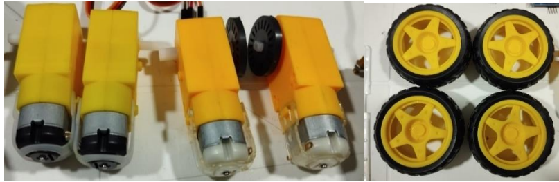
Figura 24 Motores de un eje y de doble eje con encoder y ruedas.
