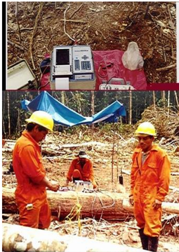
Figura 32. Cámara McSeis-160MX registrando un Uphole. (Foto tomada por Roger Martínez, campamento Belén Perú 1999).
