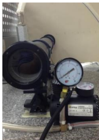
Figura 32. Turbulador, manómetro analógico de verificación inicial y compresor.
