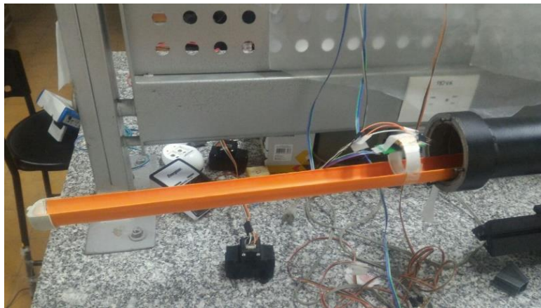
Figura 34. Ilustración con canal de agua afuera, pero que va al interior del Turbulador para la generación de la humedad relativa en su interior.
