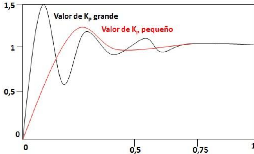
Figura 14. Señal de salida al variar la constante proporcional K_p .
