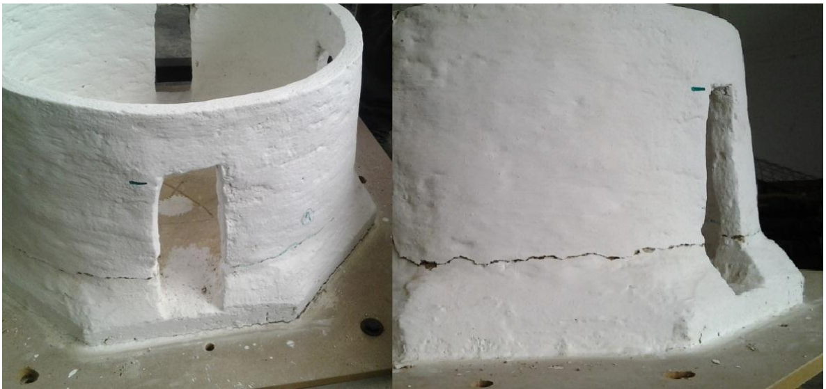
Figura 59. Estructura a escala de una vivienda con muros cuadrados en ladrillo de adobe.
