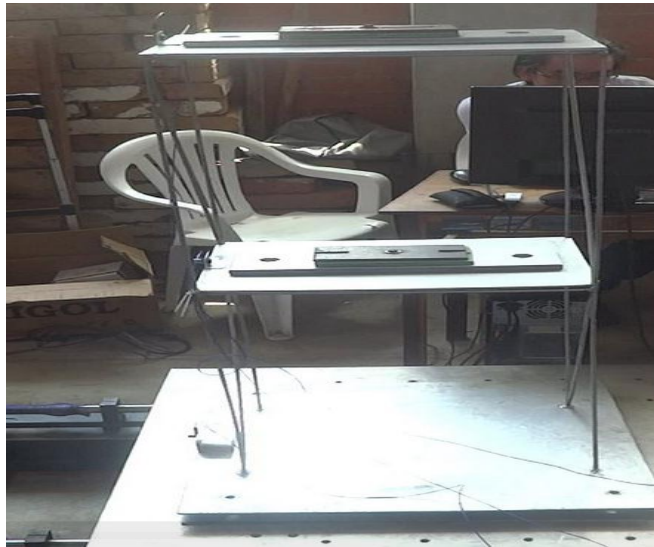
Figura 57. Estructura a escala de un aislador sísmico tipo péndulo de fricción.
