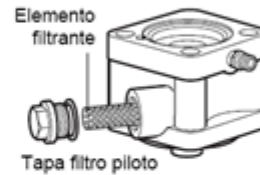
Imagen 2. Cambio de elemento Filtrante.
