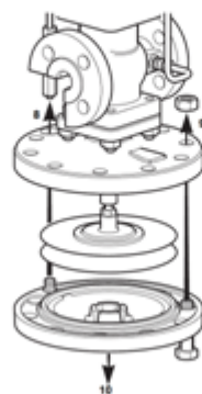
Imagen 12. Sustitución de la Válvula Prindpal. Parte 3.
