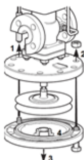
Imagen 9. Sustitución de diafragmas Principales. Paso 1,2,3,4.
