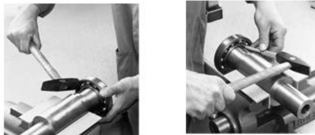
Ilustración 2. Izquierdo: Desmontaje Incorrecto. Derecho: Desmontaje Correcto (Usar Punzón Blando).
