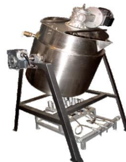
Figura 4. Tanque de Calentamiento con agitador
