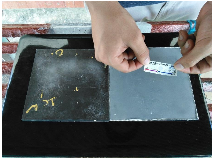
Figura 71. Medición por el método de cintas, paso 1: Pegado
