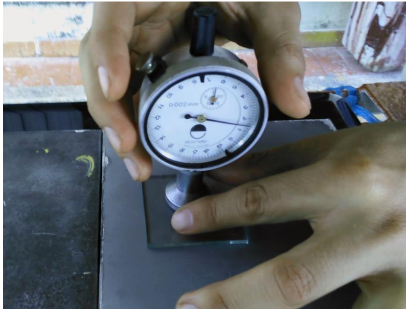
Figura 74. Medición por el método de aguja, paso 1: Ajuste del cero
