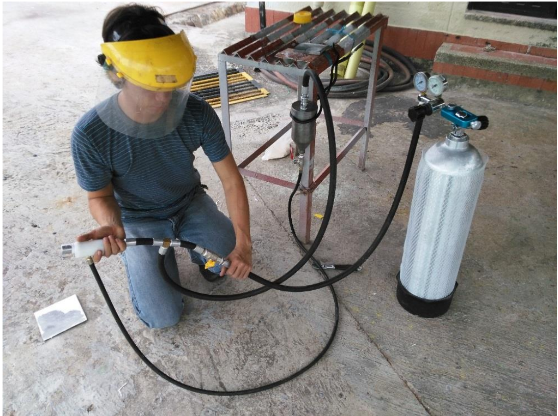
Figura 58. Segunda fase: Prototipo sin boquilla venturi
