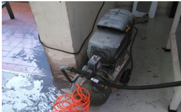
Figura 55. Compresor KTC de 2HP, 100[psi]
