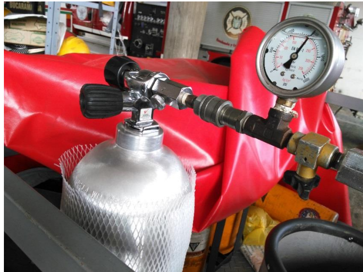
Figura 57. Llenado del tanque de suministro de aire
