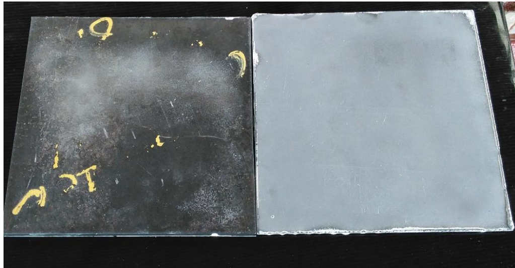
Figura 64. Tercera fase: Preparación superficial obtenida
