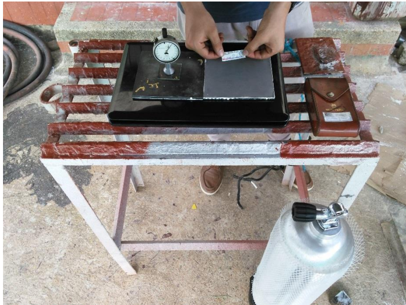
Figura 68. Medición del perfil de anclaje
