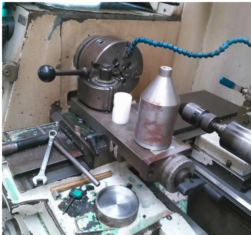
Figura 48. Tanque de arena mecanizado
