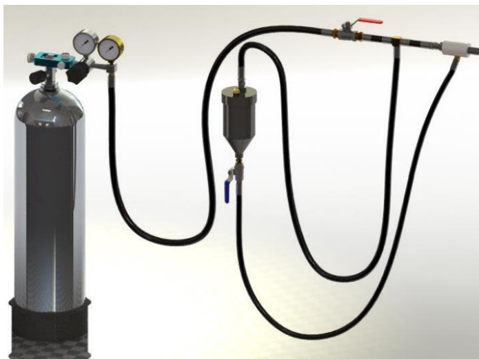
Figura 10. Diseño final del prototipo para preparación local de superficies
