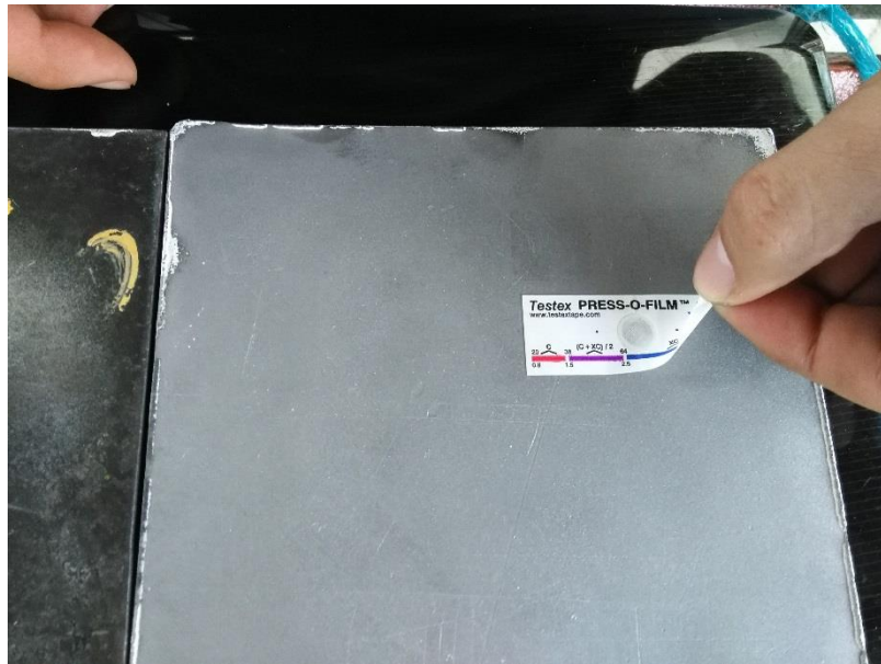
Figura 73. Medición por el método de cintas, paso 3: Medición
