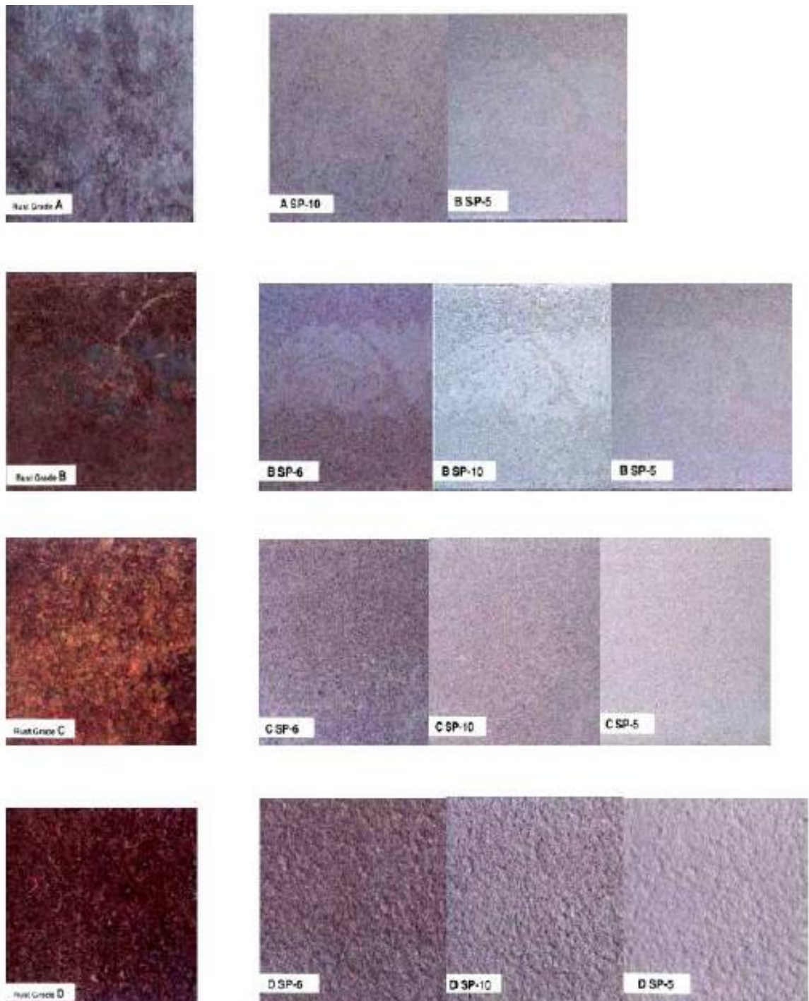
Figura 84. Grados de preparación de superficies 15 .
