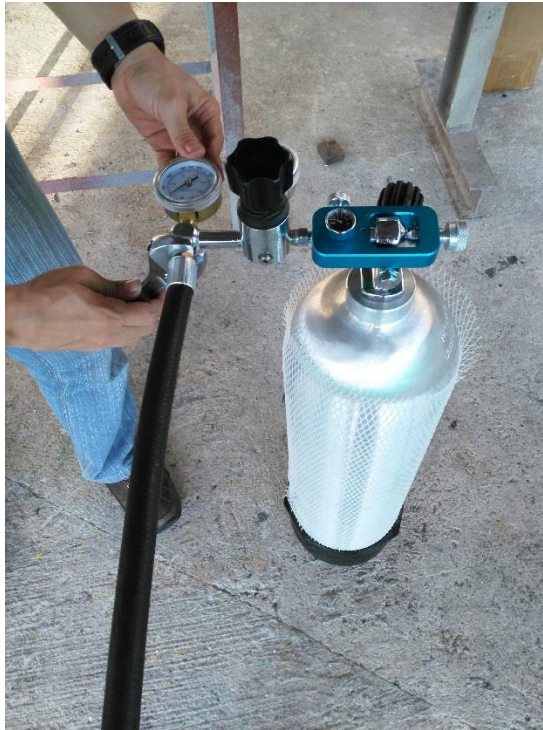
Figura 53. Acople de accesorios al conjunto de regulación de presión
