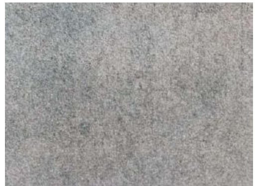
Figura 66. Patrón visual establecido por la norma SSPC para una corrosión grado A con una preparación A Sa 2 ½
