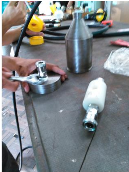
Figura 51. Roscado y ajuste de accesorios
