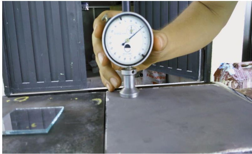
Figura 75. Medición por el método de aguja, paso 2: Toma de medidas sobre la superficie
