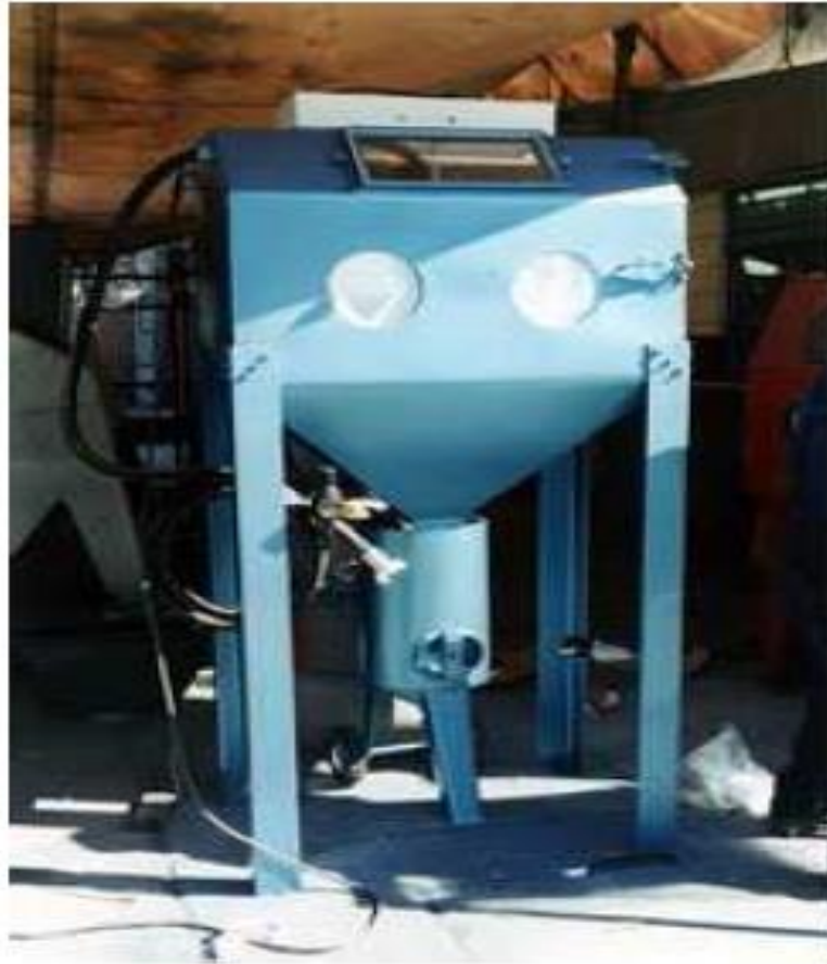
Figura 82. Equipo de sandblasting por succión.
