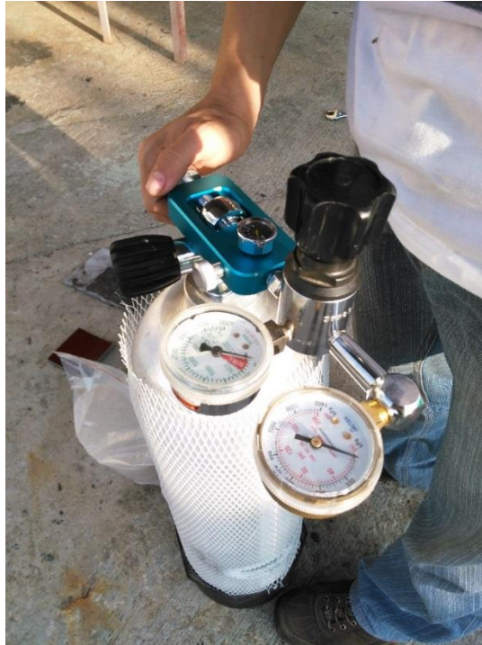
Figura 52. Ensamble de la válvula reductora de presión
