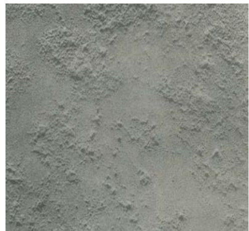
(b) Superficie con limpieza hasta Metal Blanco
