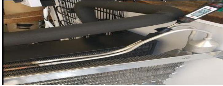
Figura 34. Temperatura de condensación al final del evaporador
