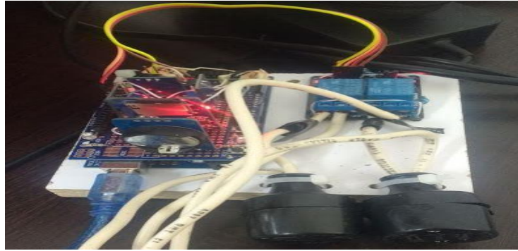
Figura 40. Hardware final del controlador de riego y encendido del AWG
