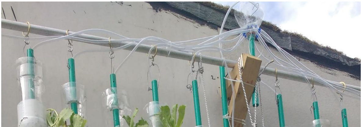
Figura 31. Tanque distribuidor de riego para la pared verde modular
