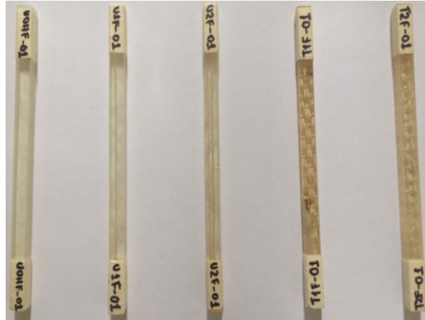
Figura 11. Probetas para el ensayo de flexión.
