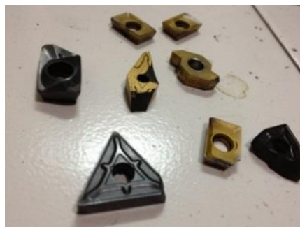
Figura 3. Herramientas rotas por uso inadecuado
