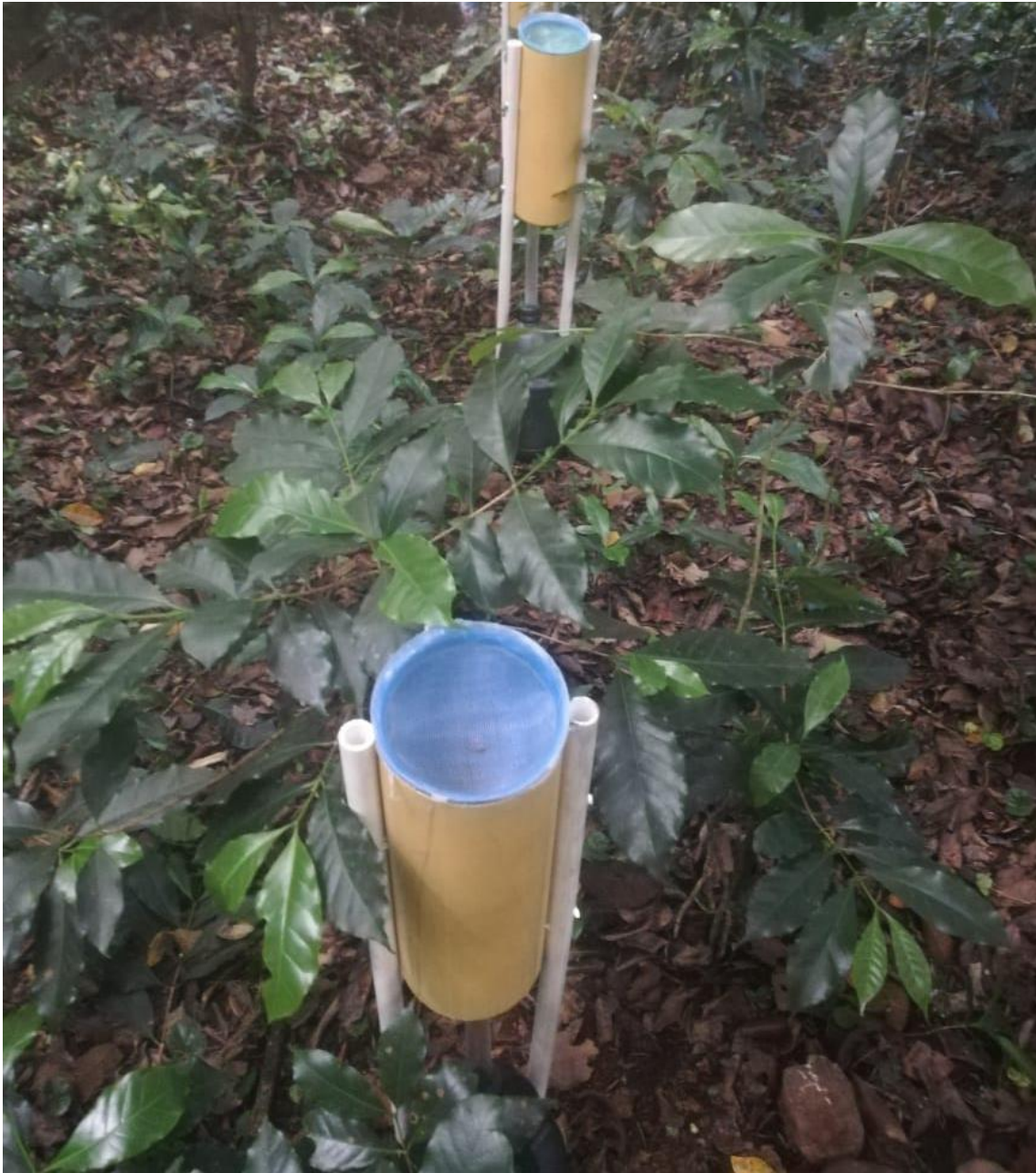
Apéndice D. Pluviómetros debajo del dosel para medir la precipitación interna
