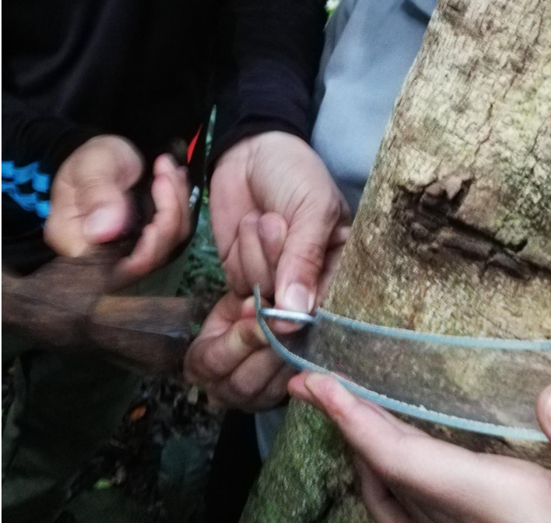
Apéndice G. Fijación de collarines a la corteza de los árboles.
