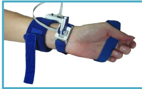
Ilustración 48. Conexión del sensor al mecanismo de leva.
