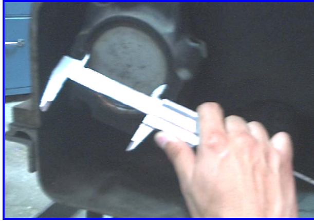
Fig. D13. Medición del diámetro de los muñones del cigüeñal.
