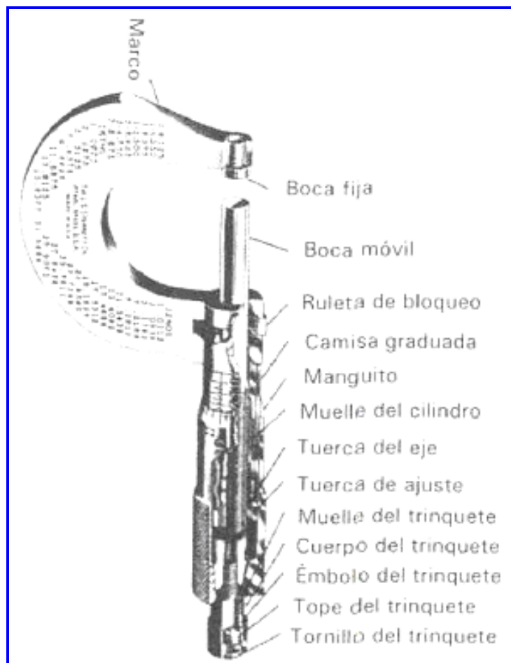
Figura 8. Micrómetro externo y sus partes.
