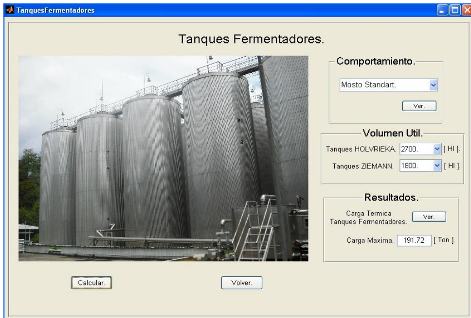
Figura 26. Interfaz grafica para el cálculo de carga térmica en tanques fermentadores
