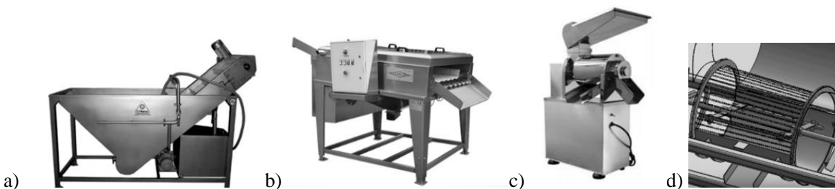
Figura 9. Lavadora de pulpa de frutas a) por inmersión y b) de cepillos. c) Despulpadora de fruta cilíndrica con tamiz rotatorio. d) Sistema interno de la despulpadora. Adaptado de Citalsa (s.f), Omip (s.f)., Caval (s.f.), Djgasli (2015).
