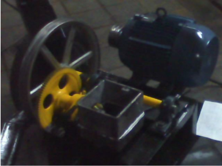
Figura . Montaje de la transmisión con caja de lubricación
