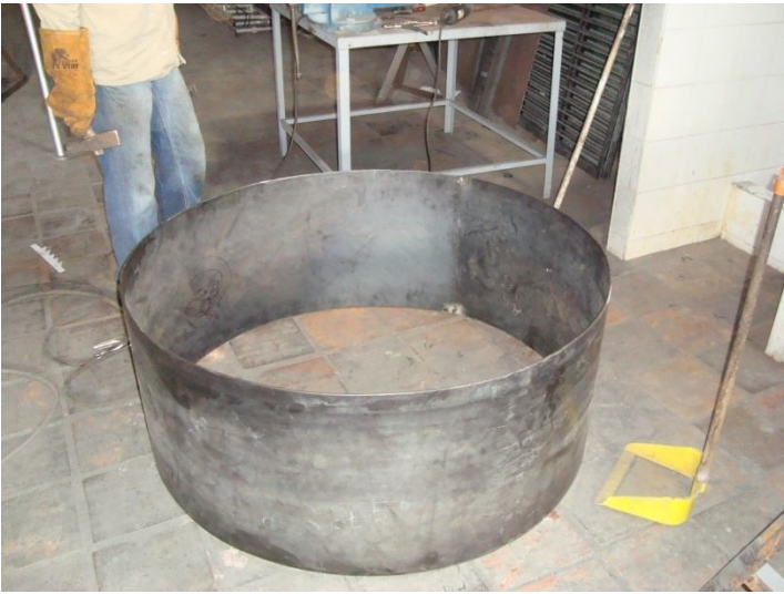
Figura . Lamina doblada para el tanque
