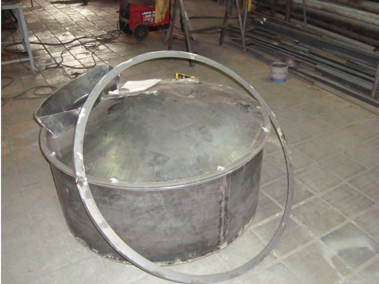
Figura . Partes del tanque a soldar
