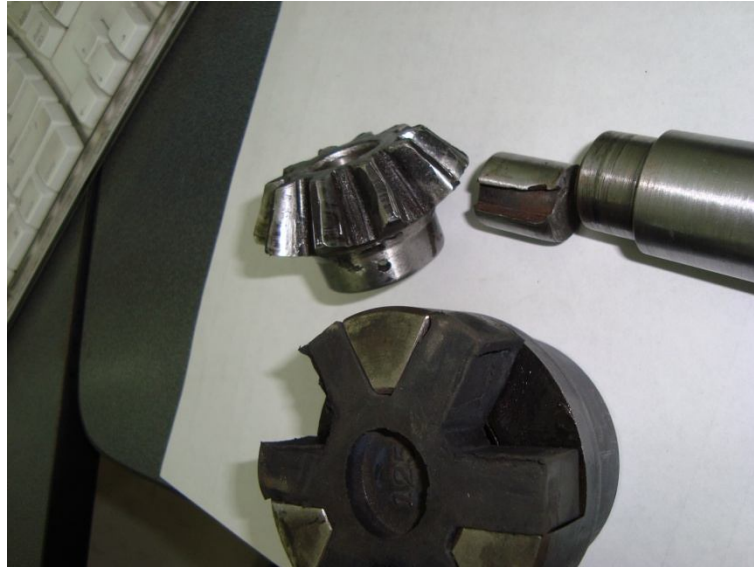
Figura . Fallas en elementos de la transmisión
