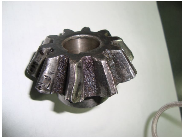
Figura . Desgaste y falla en piñón cónico
