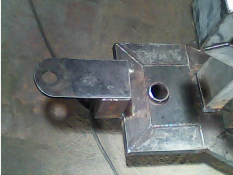
Figura . Punto de remolque en la estructura
