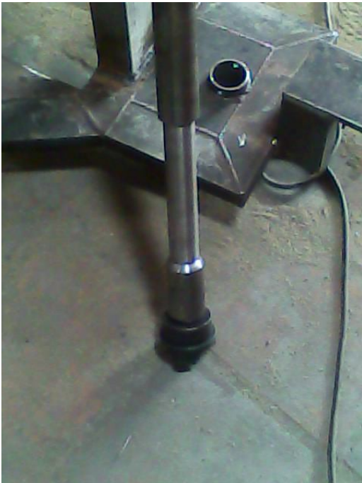
Figura . Eje vertical con acople instalado
