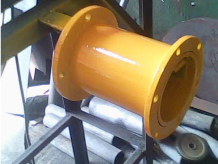
Figura . Pintura de spool para el tanque
