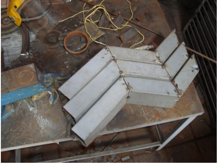
Figura . Soportes del tanque
