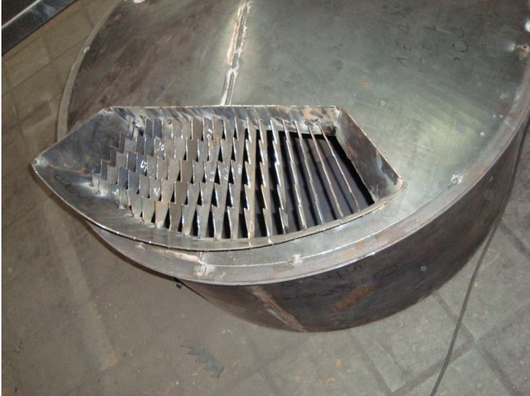
Figura . Rejilla en tolva superior
