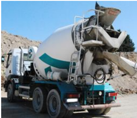
Figura . Camión hormigonera (mezclador) de 3 ejes
