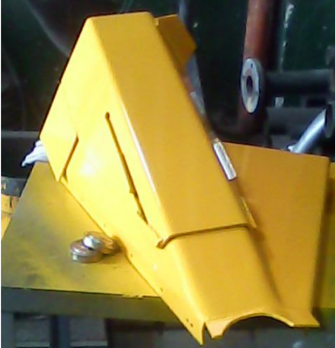
Figura . Pintura de la tolva de descarga
