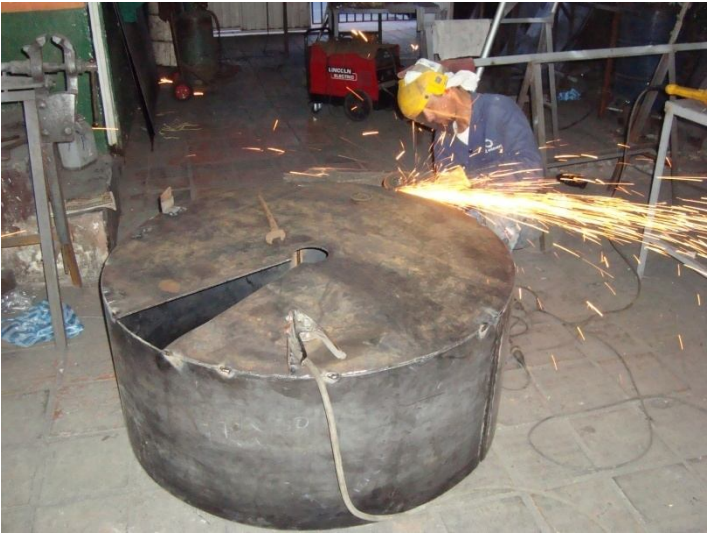
Figura . Trabajo con pulidora para colocar cordón de soldadura
