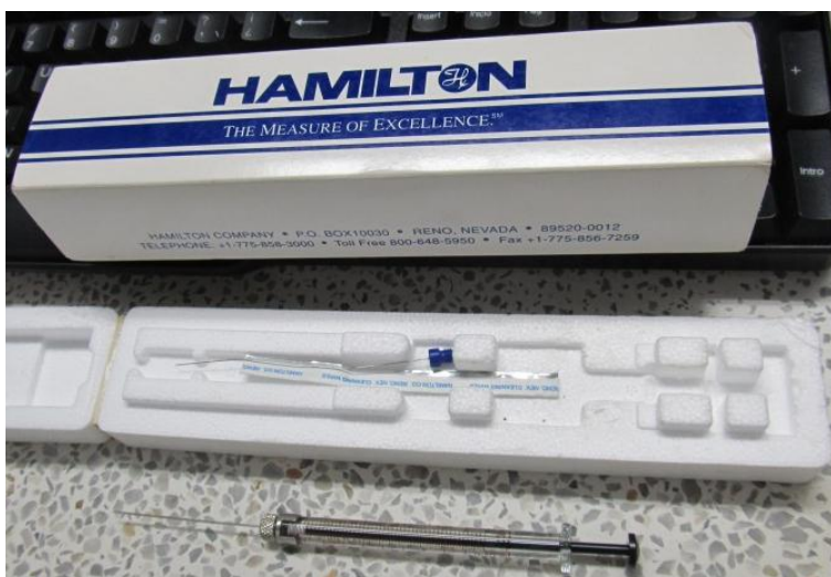
Figura 34. Jeringa para gases marca Hamilton de 500 \mu L.
