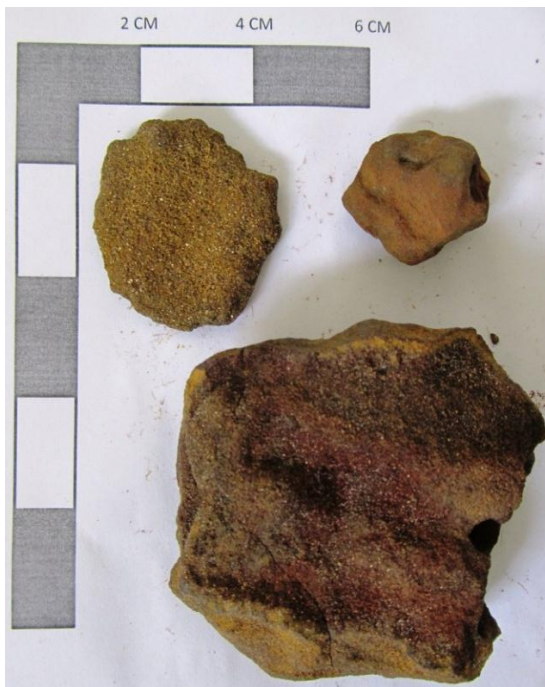
Figura 81. Xenolitos de areniscas con cemento ferruginoso.
