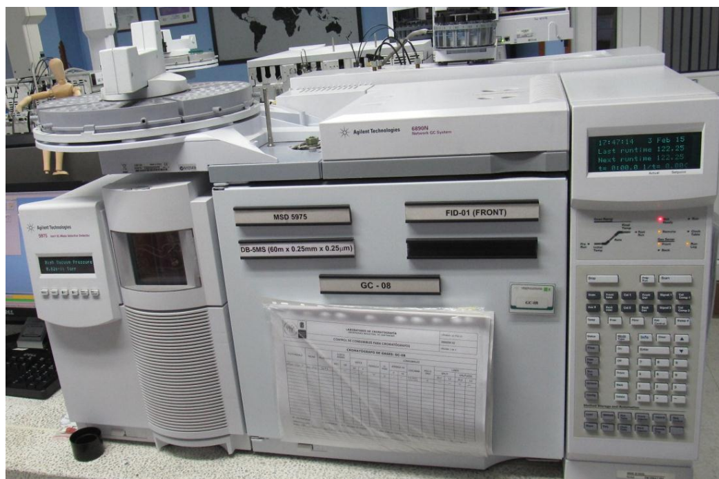
Figura 35. Cromatógrafo de gases acoplado a un detector selectivo de masas (GC-MS), marca Agilent Technologies, modelo 7890a.
