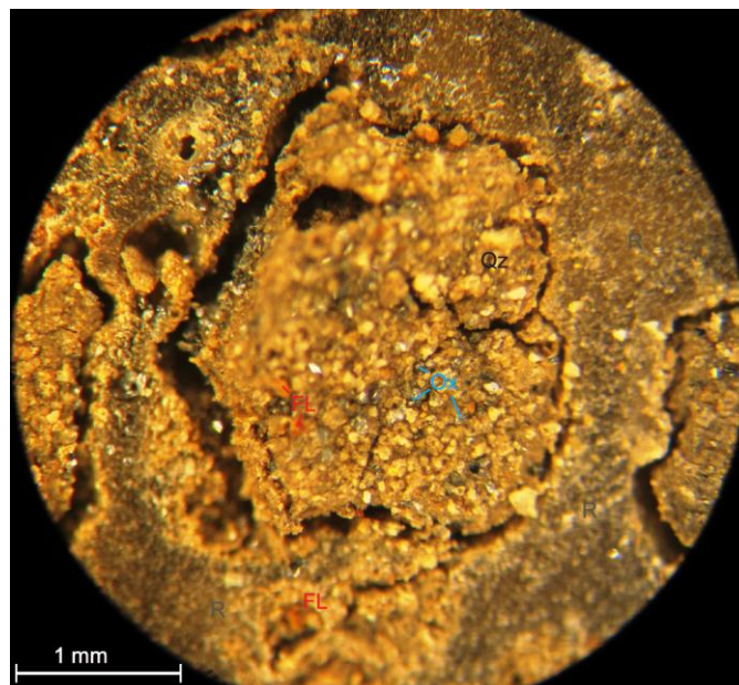
Figura 64. Muestra de lodo LR-03, foto tomada en el estéreomicroscopio para observar los xenocristales. Cuarzo (Qz), Fragmentos líticos (FL), Oxidos (Ox), Resina (R).
