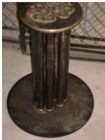
Figura 6. Haz de tubos de la caldera pirotubular
