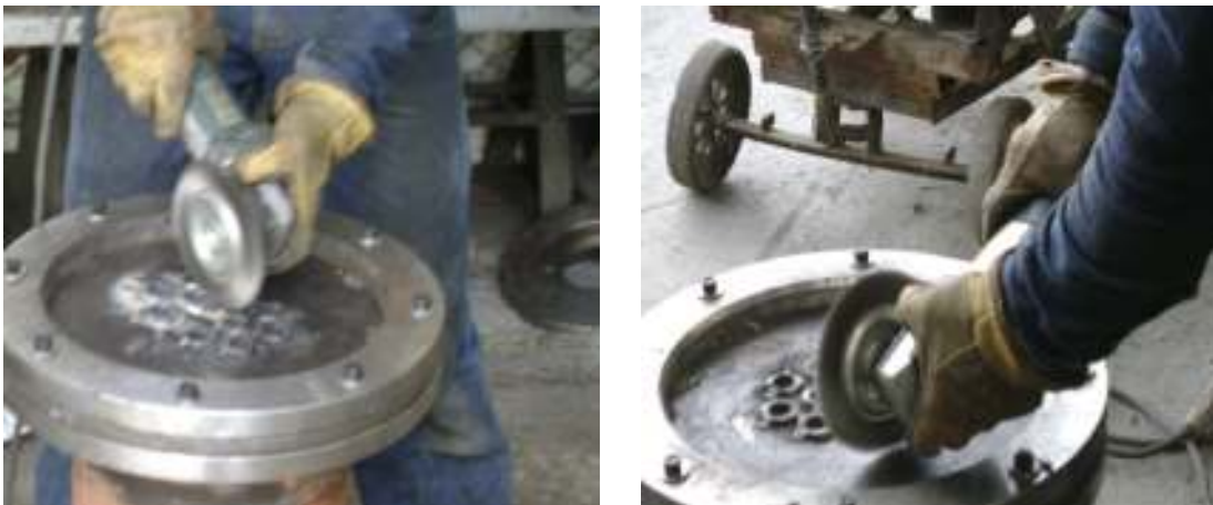
Figura 43. Pulido del haz de tubo
