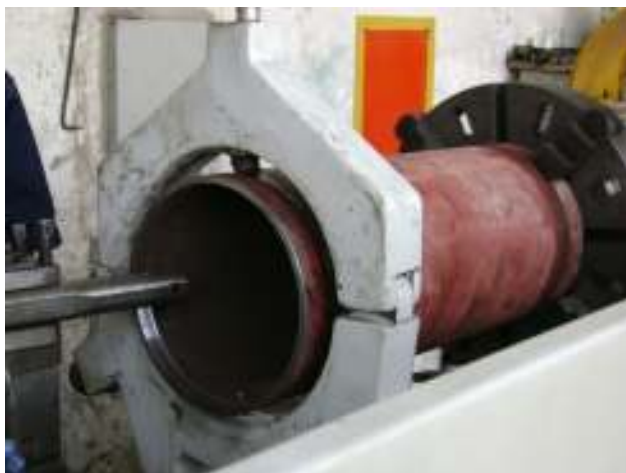
Figura 39. Rectificado de tubo
