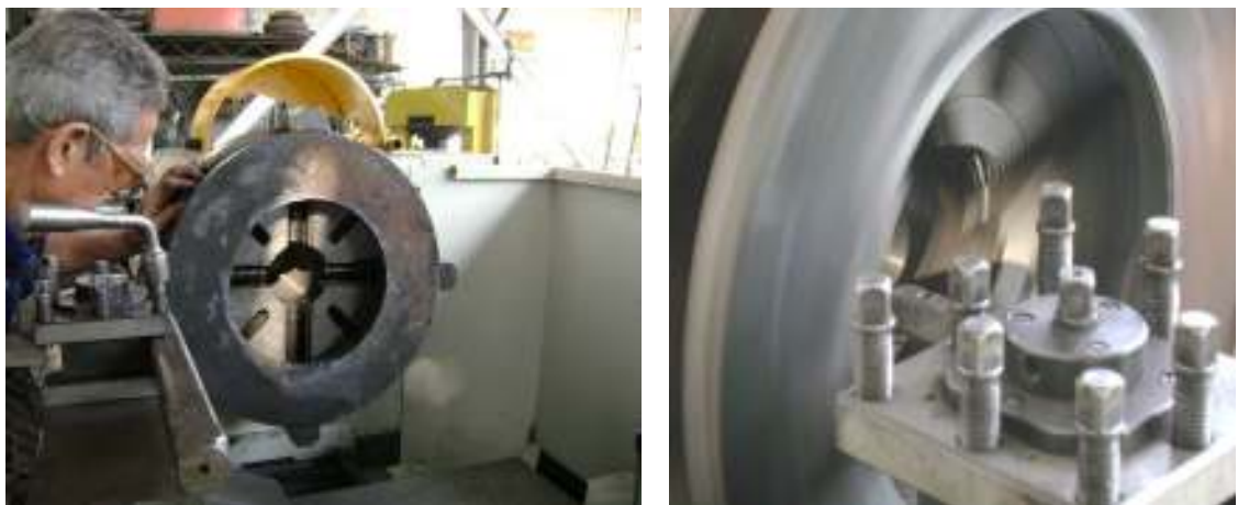
Figura 36. Construcción de las bridas
