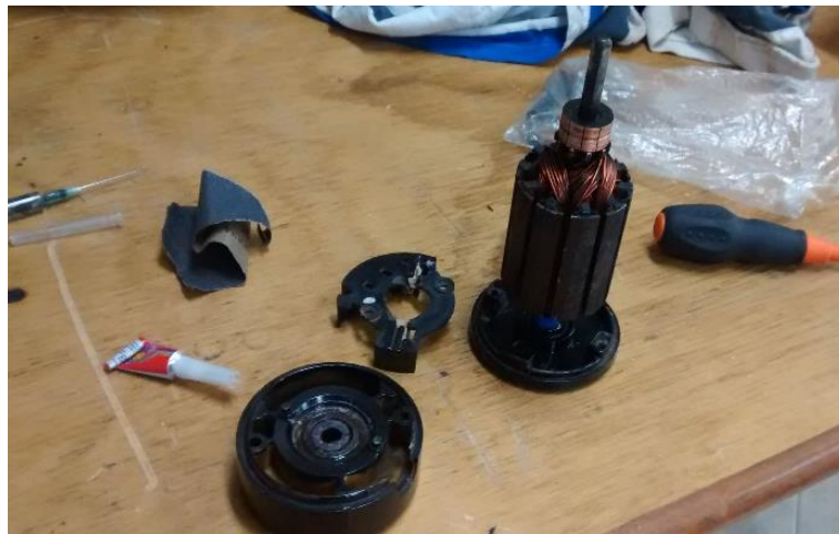
Figura 26. Rotor, rodamientos y caja de escobillas del motor
