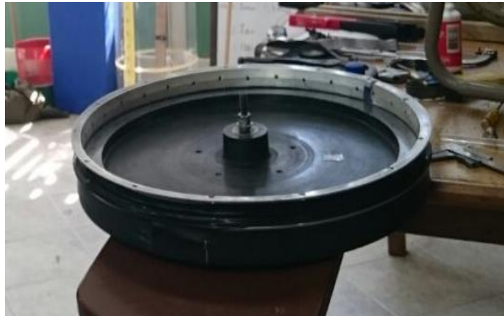
Figura 29. Implementación de la polea en V para el volante de inercia de la bicicleta estática
