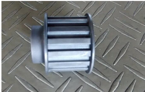
Figura 28. Polea acoplada al generador en el sistema de transmisión
