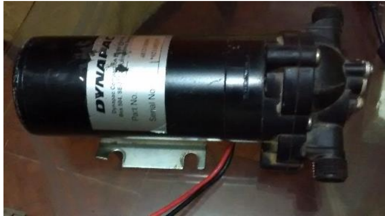
Figura 25. Motor DC empleado como alternativa de generación
