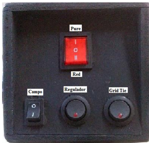
Figura 19. Tablero de control ubicado en la bicicleta
