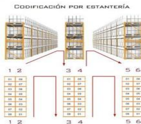
Figura 14. Codificación por estanterías
