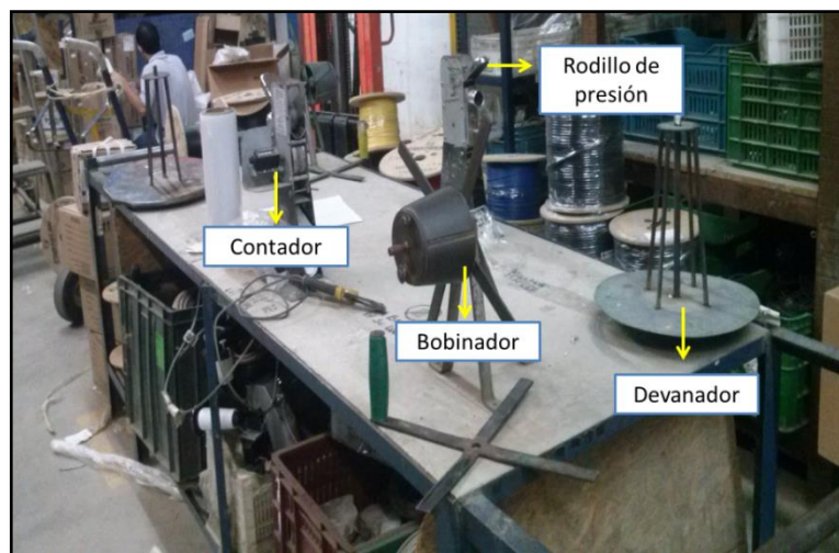
Figura 12. Partes de medidores de cable
