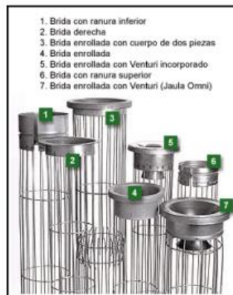
Figura 7. Tipos de construcciones de la parte superior de canastillas.
