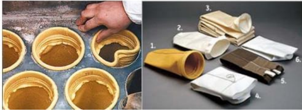
Figura 6. (A). Placa portamangas y bolsas filtrantes. (B). Tipos de mangas filtrantes.
