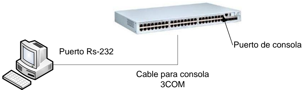
Figura 5.1 Diagrama de conexión usando el puerto de consola 2 .
