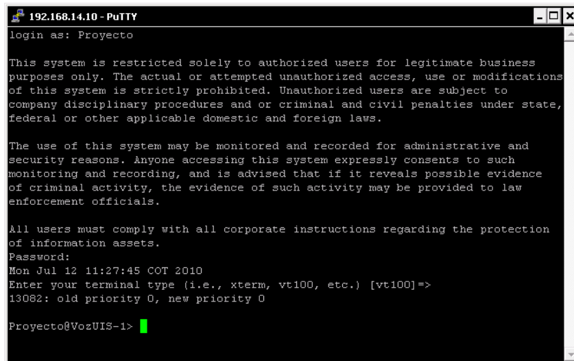
Figura 3.10 Vista del sistema de consola usando Putty 1 a través del protocolo SSH.
