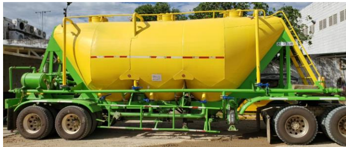
Figura 8. Tolva de cemento.
