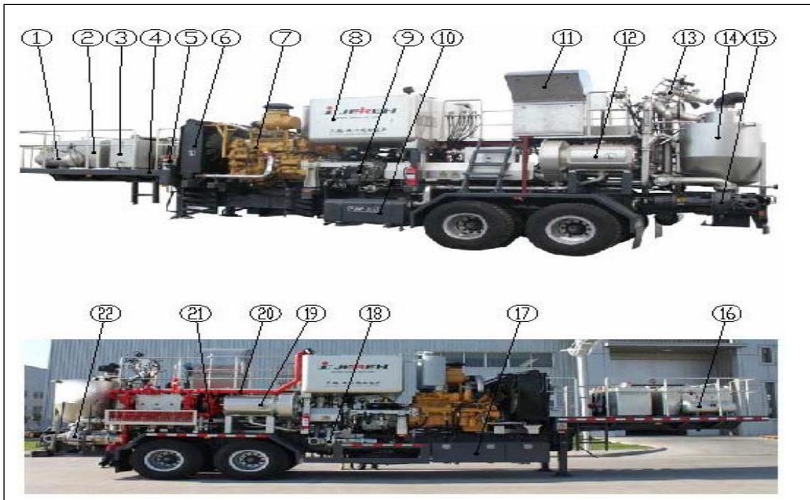
Figura 13. Identificación componentes de la unidad de cementación Jereh GJT70-34II
