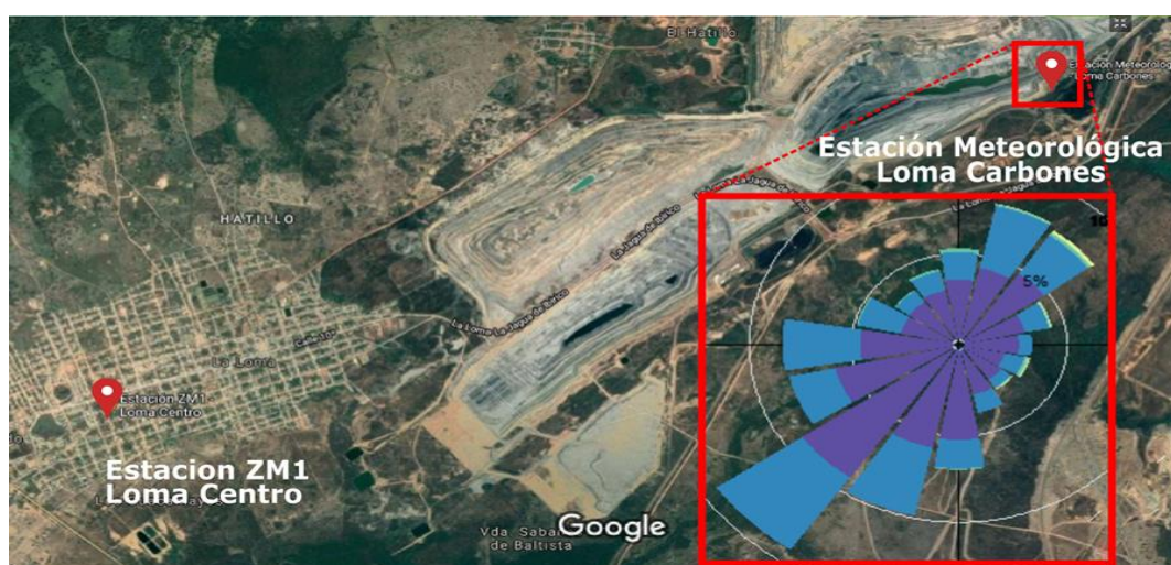
Figura 9. Ubicación de la Rosa de Viento sobre mapa de la estación meteorológica Loma Carbones del Cesar
