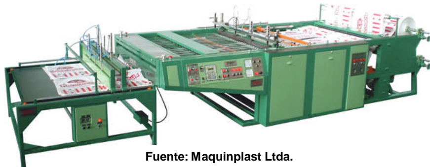
Figura 15. Máquina Confeccionadora de Bolsas Plásticas
