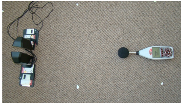
Figura 28. Configuración final de los parlantes (3 cm de separación)
