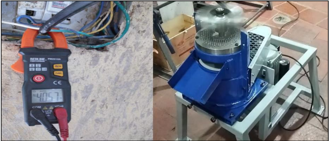
Figura 44. Consumo de corriente del motor sin carga
