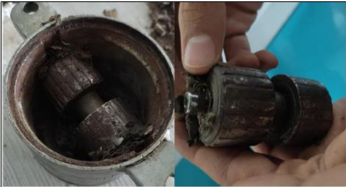
Figura 12. Rodillos de peletizadora de matriz giratoria
