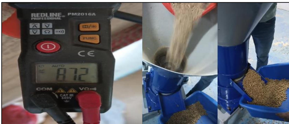
Figura 45. Consumo de corriente del motor con carga
