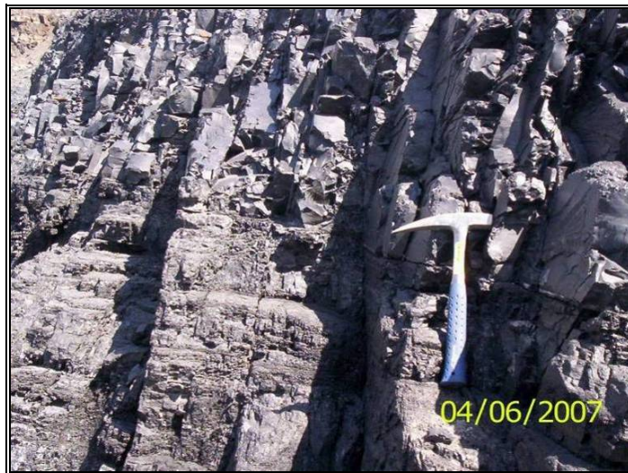
Figura 17. Manto 45 (Tajo Tesoro): Presencia de cleats perpendiculares a la dirección del buzamiento.
