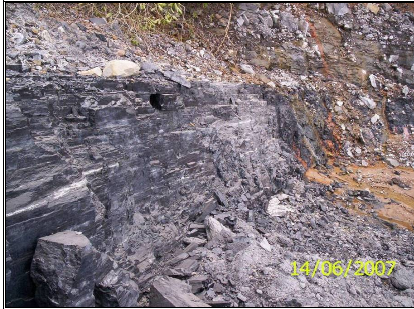
Figura 55. Manto 03U (Tajo López): Este manto presenta un a leve laminación y estratificación.
