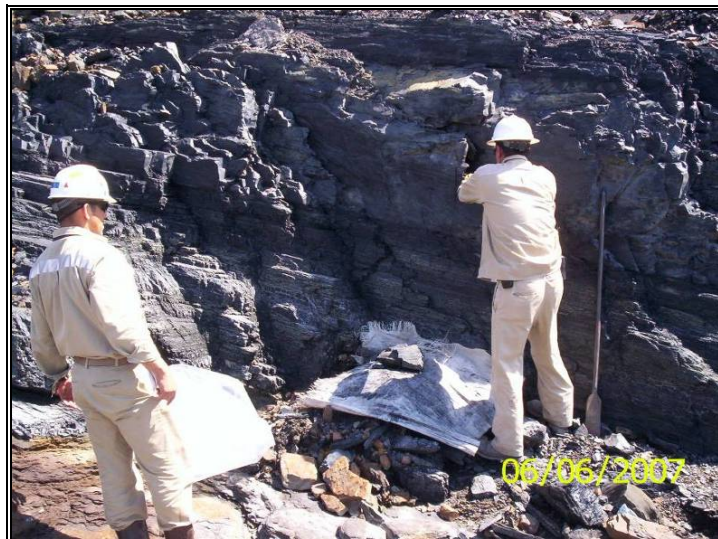
Figura 11. Recolección de las muestras en una lona de tamaño y calibre apropiado
