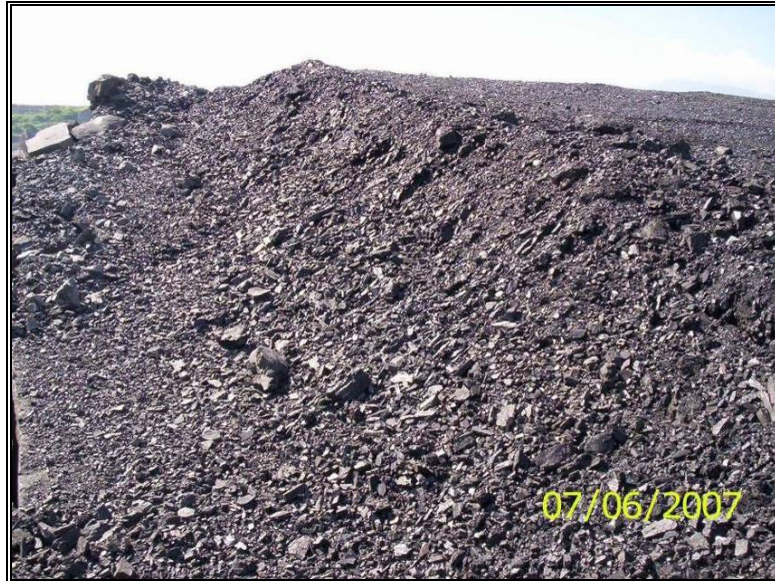
Figura 24. Manto 17 (Tajo Tesoro): Litotipo Clareno con presencia de cleats y levemente estratificado.
