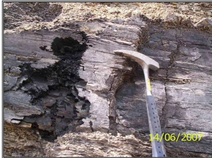
Figura 53. Manto 03A (Tajo López): Este manto se compone del litotipo Clareno y particularmente presenta fractura concoidea.
