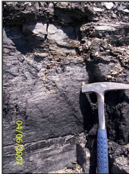
Figura 27. Manto 09 (Tajo Tesoro): Presenta litotipo clareno y fuseno de acuerdo a su brillo característico, es bastante compacto. Se observa línea divisoria a 17 cm. de la base del manto.
