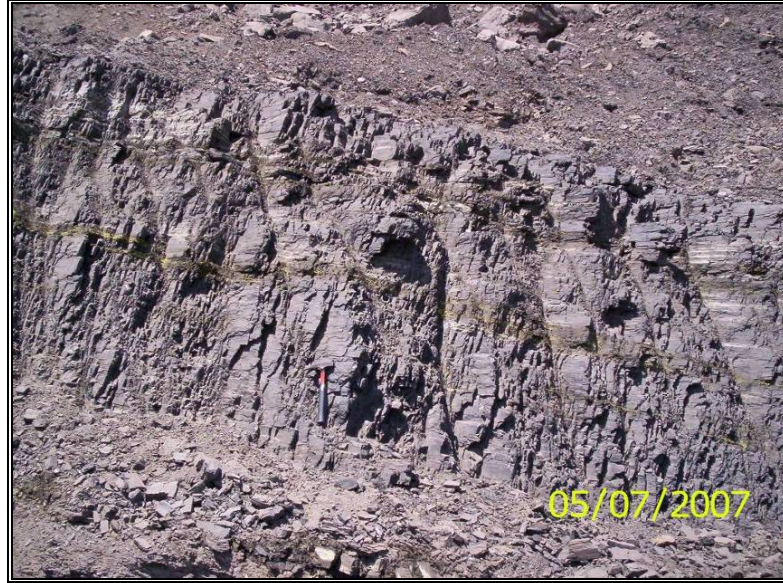
Figura 22. Manto 20 (Tajo Tesoro): Presencia de azufre de tipo orgánico, el cual se evidencia a través de las líneas amarillas en el manto.
