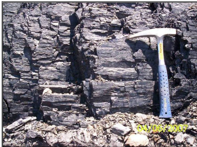
Figura 29: Manto 08 (Tajo Tesoro): Este manto presenta estratificación y cleats perpendiculares al buzamiento.
