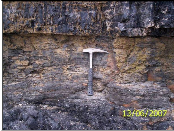
Figura 45. Intermedio M10 y M11: Esta litología separa ambos mantos, es de tipo arcilloso y presenta meteorización.
