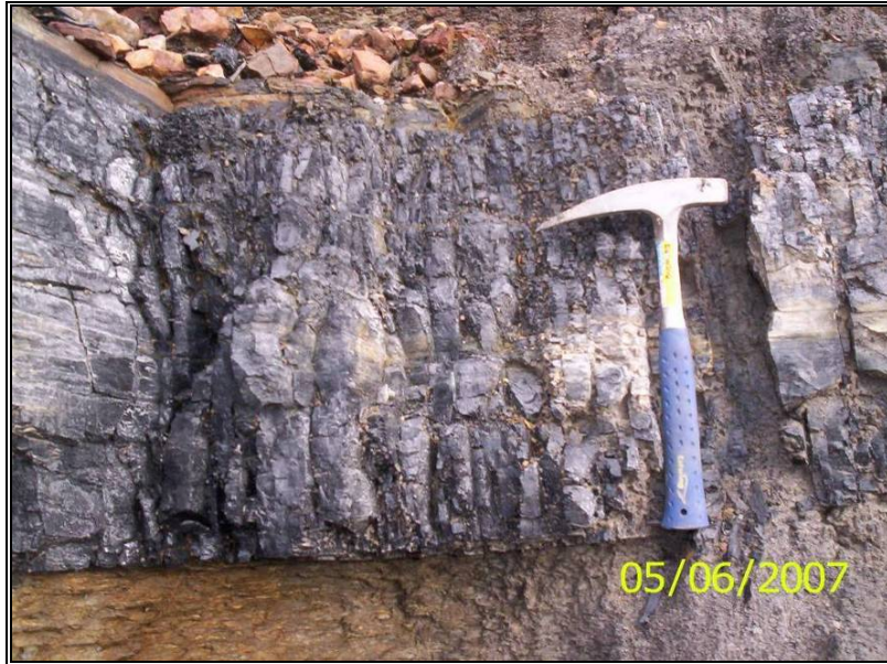
Figura 32. Manto 03A (Tajo Tesoro): Evidentes cleats perpendiculares al buzamiento.
