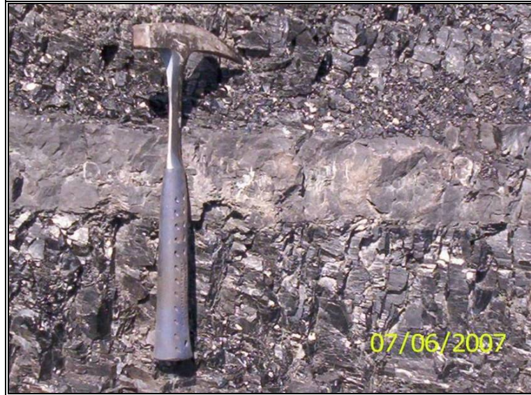
Figura 26. Manto 10 (Tajo Tesoro): Presencia de un lente siderítico que aparece solo en algunos sectores.
