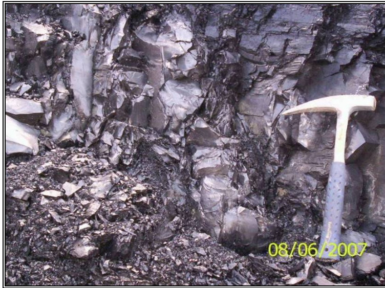
Figura 37. Manto 45 (Tajo Sur): Vista de cerca del litotipo Dureno, el cual presenta fractura concoidea y un mayor grado de compactación en comparación con los otros litotipos.
