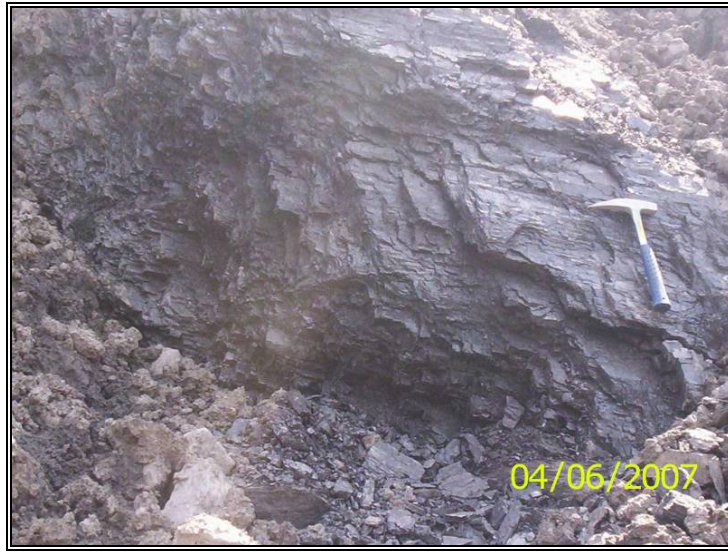
Figura 18. Manto 30 (Tajo Tesoro): Presencia de cleats perpendiculares al buzamiento y estratificación leve.
