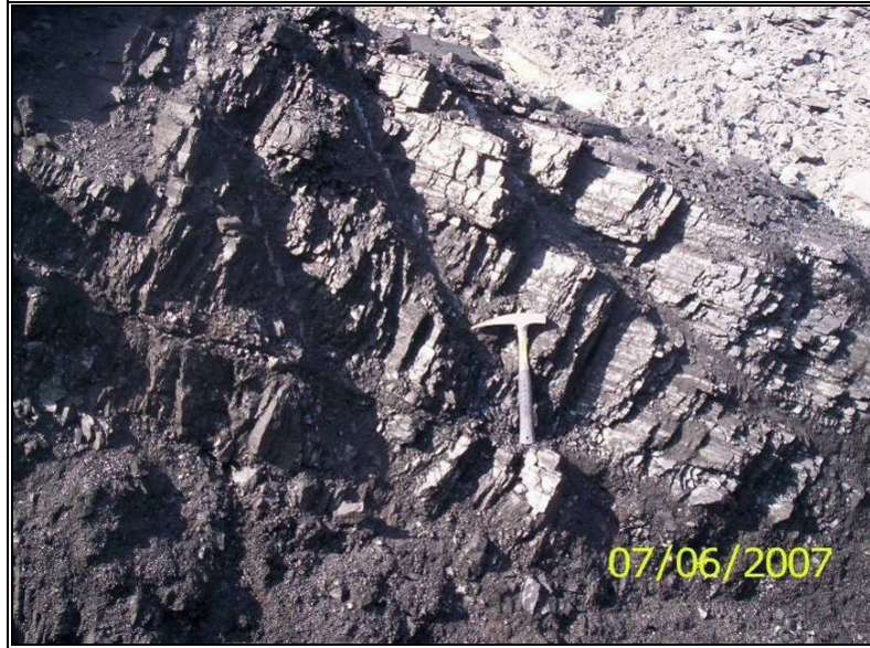
Figura 39. Manto 40 (Tajo Sur): El manto presenta Litotipo Clareno y cleats perpendiculares a la dirección del buzamiento.
