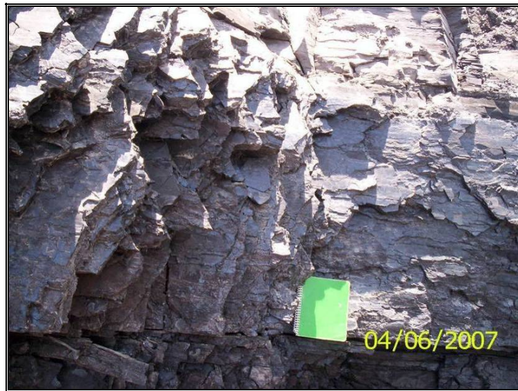
Figura 19. Manto 28 (Tajo Tesoro): Litotipo Vitreño con presencia de estratificación y cleats.
