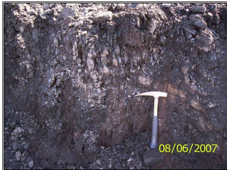
Figura 42. Manto 30 (Tajo Sur): Cleats perpendiculares a la dirección del buzamiento.
