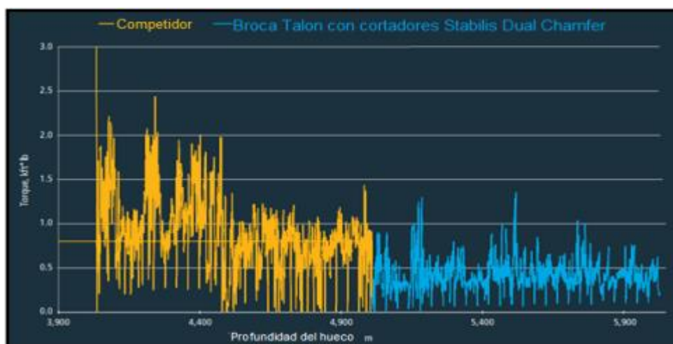
Figura 29. Comparación de torque entre broca cortadores convencionales vs Stabilis.
