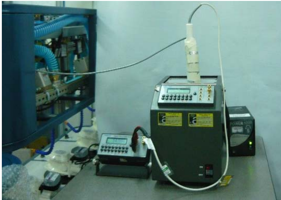
Figura 15. Calibración transmisores de temperatura
