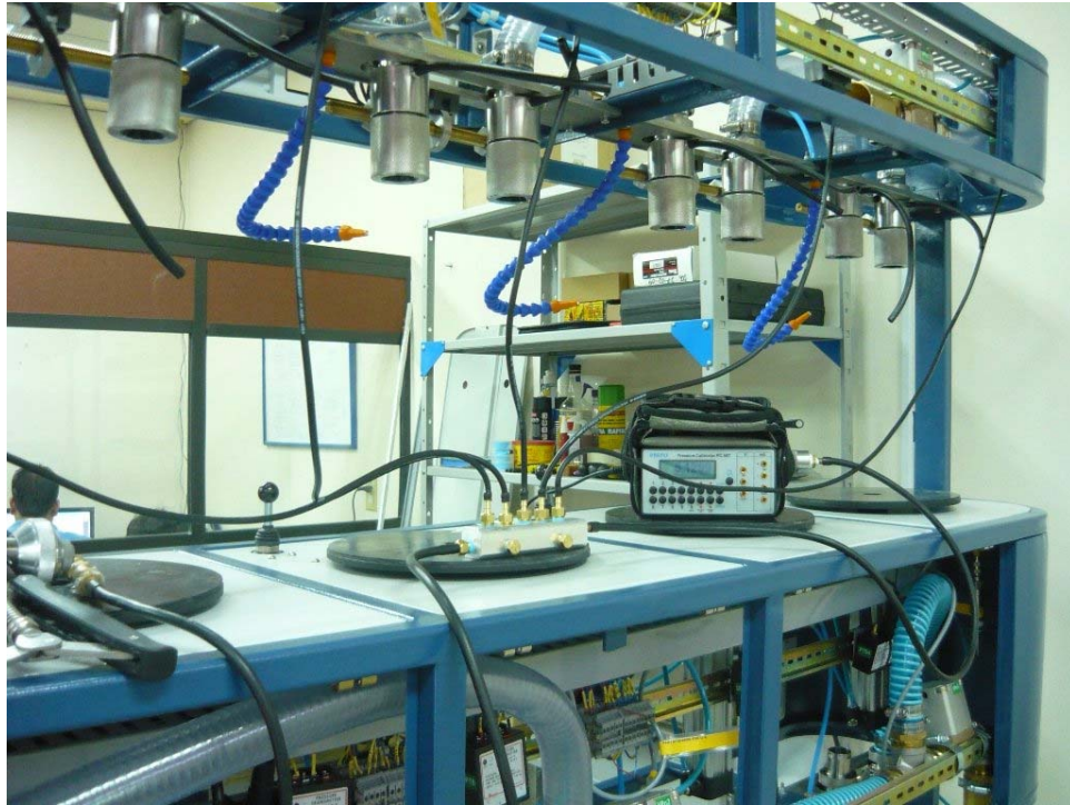
Figura 17. Calibración transmisores de Presión Diferencial
