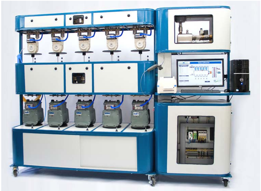
Figura 20. Instalación de los medidores durante el proceso de calibración usando el banco
