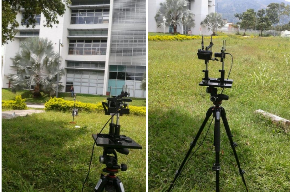
Figura 10. Sensor CMOS-3 y expansor de haz posicionados a las diferentes distancias empleadas en la experimentación.
