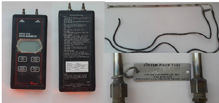
Figura 16. Instrumentos de medición de presión manómetro y tubo pitot.
