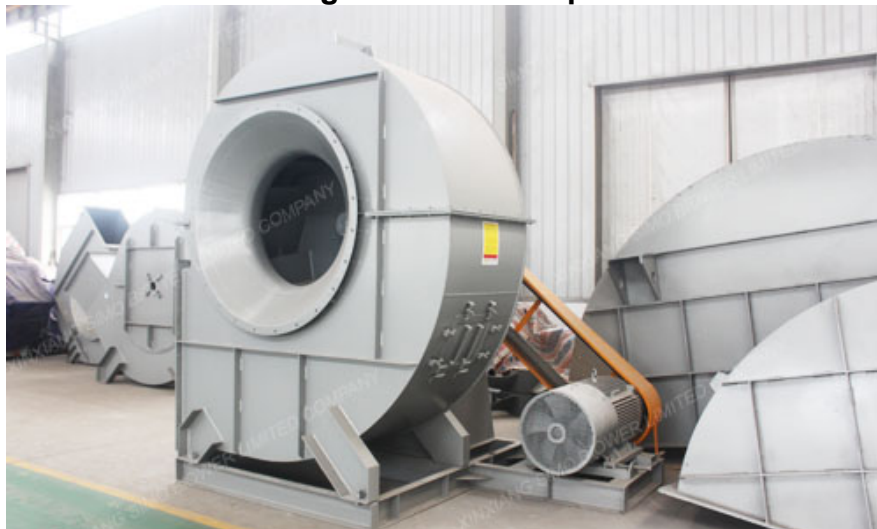
Figura 8. Ventilador centrifugo industrial de presión media.
