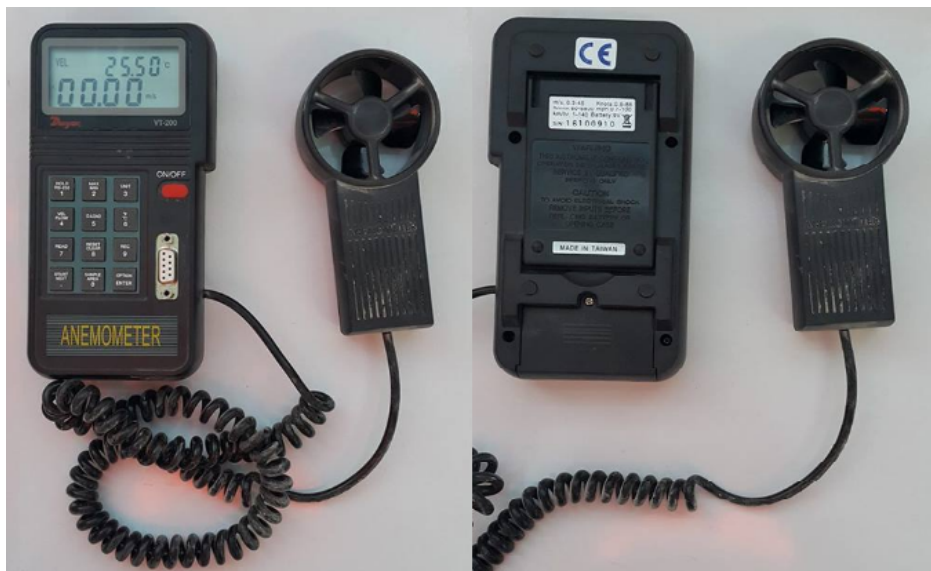
Figura 19. Instrumento de medición de velocidad anemómetro.
