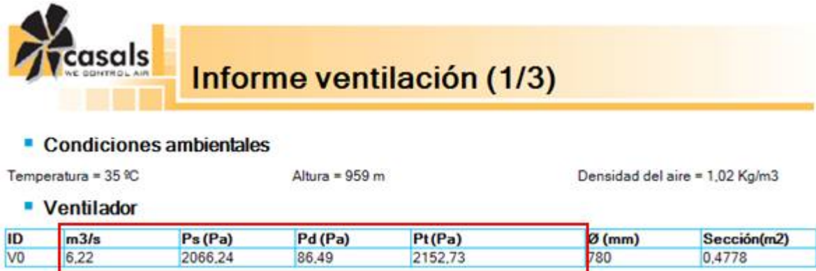
Figura 57. Informe del nuevo ventilador requerido.
