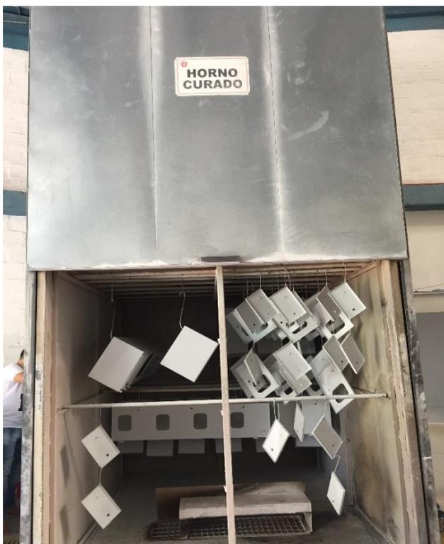
*Figura 17: Zona de Horno y Secado.*
