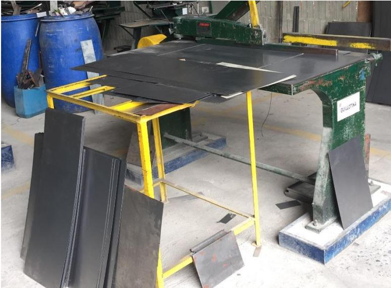
*Figura 18: Lámina de acero Cold Rolled cortada de acuerdo al producto a elaborar*
