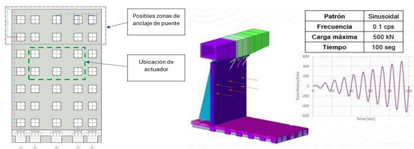
Fig. 4-Posibles posiciones de ubicación de actuador y Análisis de acciones. Fuente: Equipo de trabajo UIS.
