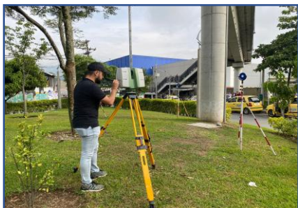
Fig 1. Escaneo puente parte inferior.
