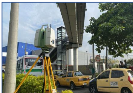
Fig 2. Escaneo puente parte inferior.
