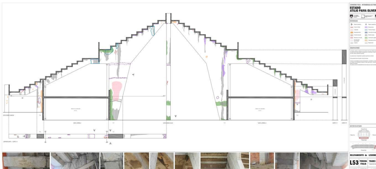
Fig. 2 – Relevamiento de lesiones en el pórtico P97-98 del Tramo 06 de la Tribuna Italia
