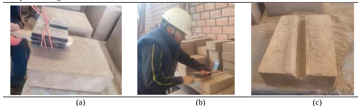
Figura 2. Ensayo de resistencia a la abrasión de los BTC; (a) Inicio del proceso con carga aplicada sobre el cepillo; (b) Proceso de ejecución; (c) Resultado visual del ensayo. Fuente: Propia
