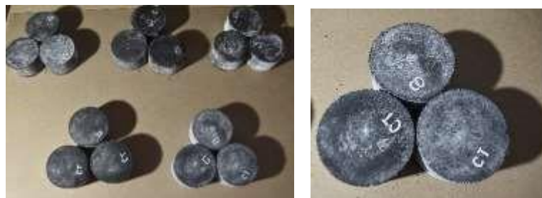
Fig. 1 – Resultado visual de los Prototipos despues de un ambiente de exposicion pH 11.5-12.5.
