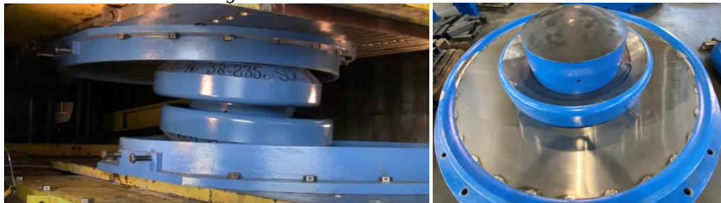
Fig. 5 – Ensayo de un prototipo de los aisladores pendulares de rozamiento triple en la mesa de EPS
