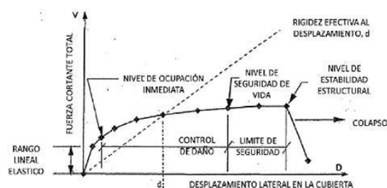
Fig. 1 – Curva típica de capacidad – Niveles de desempeño (Fuente ATC-40)
