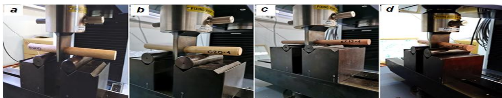
Fig. 1 – Configuración de ensayo de flexión en tarugos de madera. Series: a) E20, b) G20, c) T15 y d) T18.
