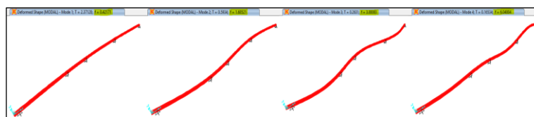
Fig 10. Formas modales del puente con sus frecuencias asociadas a cada modo.
