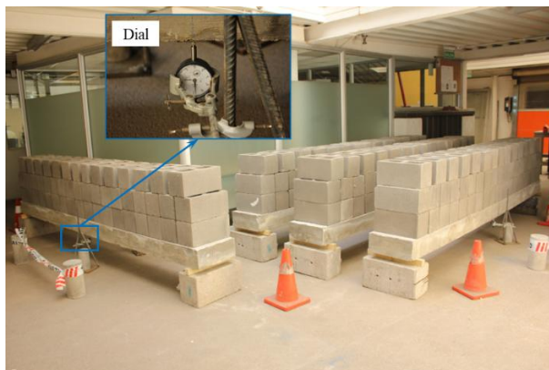
Fig. 8 - Vista general del ensayo de deflexión a largo plazo de las cuatro losetas.
