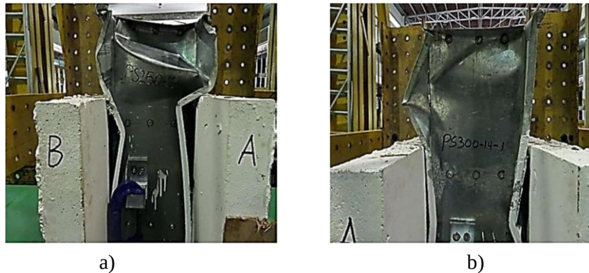
Fig. 4 – Falla por pandeo local de especímenes en sección compuesta en ensayo Push-out. a) Conectores tipo perno M16. b) Conectores tipo perno M14. [7]
