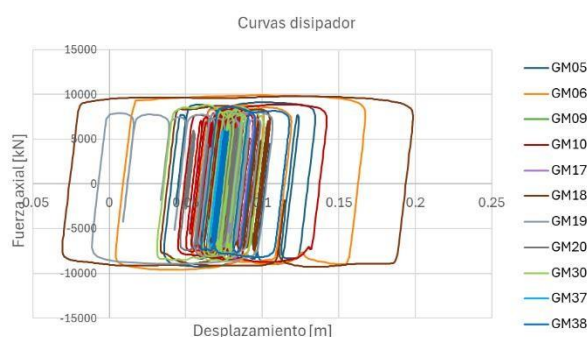
Fig. 5-Curvas de histéresis del disipador viscoso equivalente para los 11 registros sísmicos. Fuente: Elaboración Propia.
