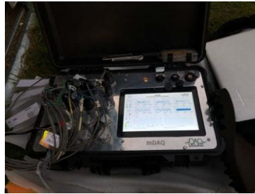
Fig. 4 – Sistema de adquisición de datos mDaq
