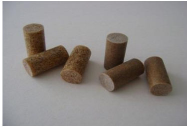
Figura 33: Probetas para ensayos de compresión.
