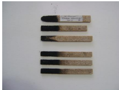
Figura 87. Probetas de la prueba de flamabilidad del material.
