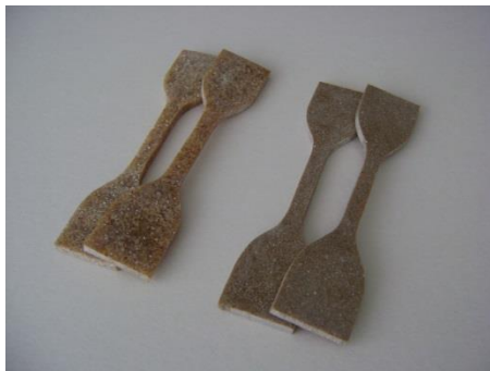
Figura 29: Probetas de tracción de tamo y resina poliéster.
