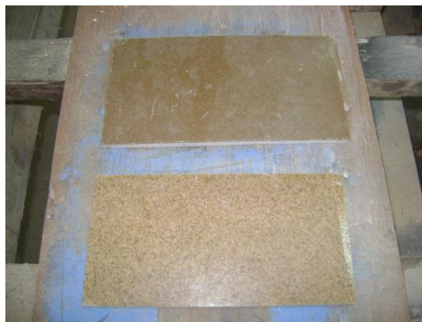
Figura 31: Material para la obtención de probetas de flexión y tracción y probetas de flexión.
