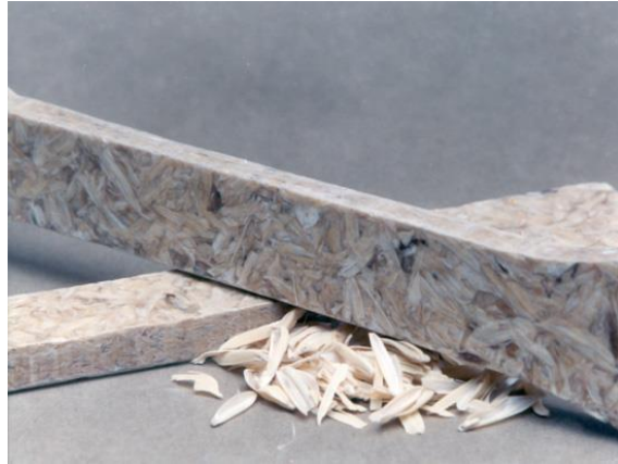
Figura 15. Probeta hecha con cascarilla de arroz y resina poliéster.
