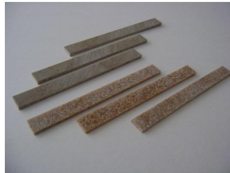
Figura 31: Material para la obtención de probetas de flexión y tracción y probetas de flexión.
