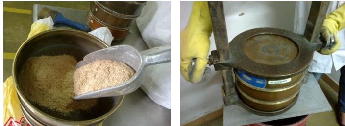
Figura 23. Tamices y clasificador de muestras.
