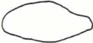
27. Bomba desgastada. Viajera y fija fugando o pistón fugando
