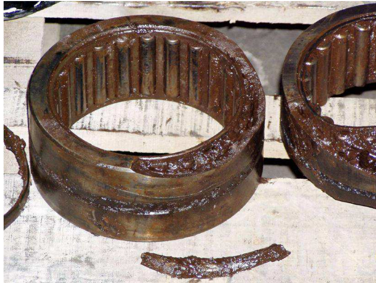
Figura 25. Rodamientos afectados por corrosión y abrasión (rotura).
