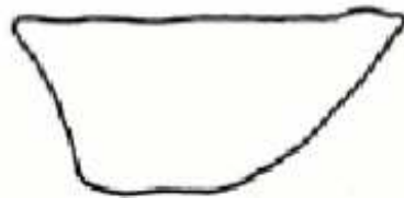
29. Combinación de válvula fija fugando e interferencia de gas
