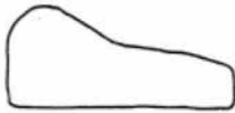
1. Bomba llena, Aceleración de fluido (fricción)
