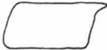
5. Golpe de fluido suave. Tubería no anclada
