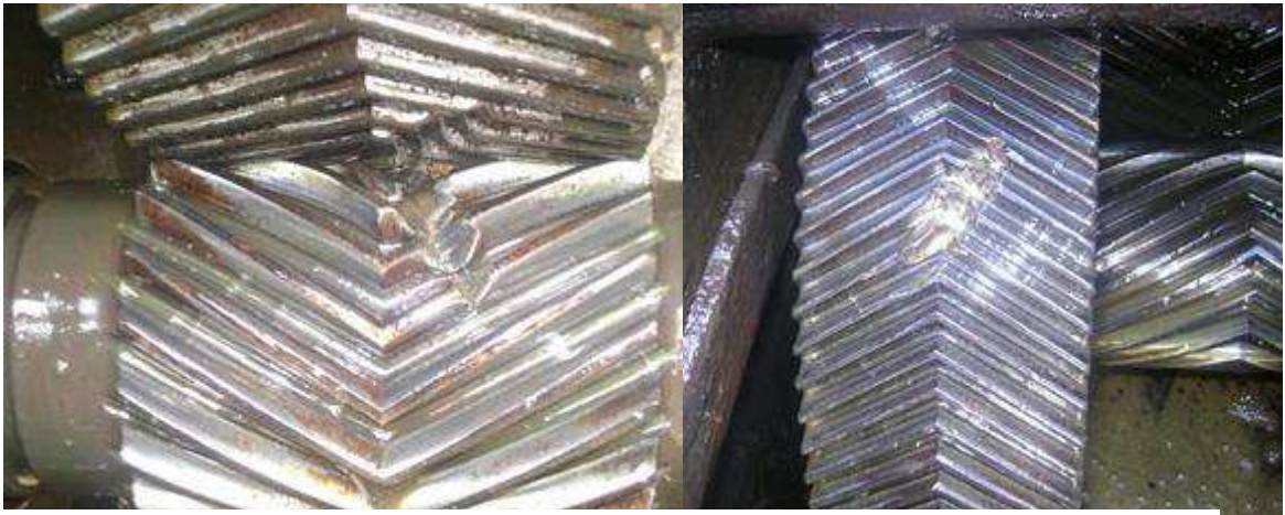
Figura 40. Falla caja reductora Colorado-40.
