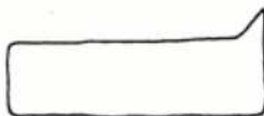
22. Bomba golpeando arriba (mucho espacio)
