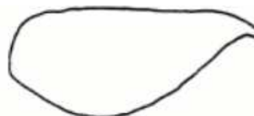
20. Combinación de fugas en la válvula fija y viajera con interferencia de gas
