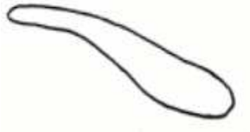
7. Golpe de fluido severo. Bomba anclada
