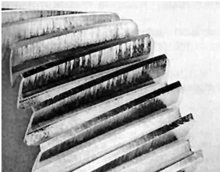
Figura 27. Rayaduras en los dientes de los engranajes
