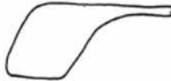
6. Golpe de fluido severo. Tubería no anclada
