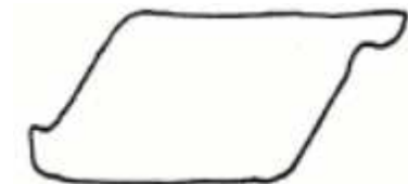
23. Mal funcionamiento del ancla de tubería
