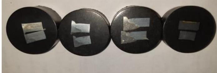
*Nota:* en la imagen se puede apreciar la zona de la soldadura con un tono distinto al del acero de control
