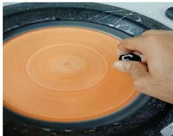
*Nota:* La probeta debe mantenerse firme en el contacto con el paño para evitar golpes que afecten la metalografía.
