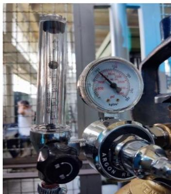
*Nota:* la mezcla del gas de protección tiene un 75% de argón y 25% de dióxido de carbono.
