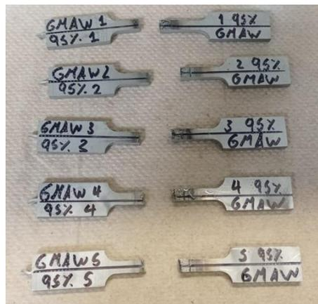
*Nota:* Se evidencia que en las probetas el fallo se dio en la junta soldada.
