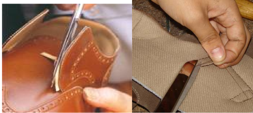
Figura 12. Corte de Sobrantes de Forro y de hilos
