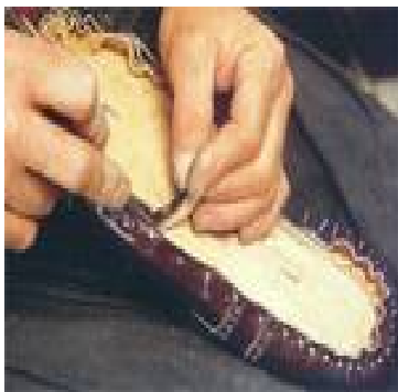
Figura 17. Roñar el corte montado a la horma
