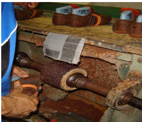
Figura 19. Cardar el corte montado
