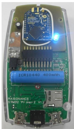
Figura 46: Primer 2 conectado adecuadamente al módulo de comunicaciones.
