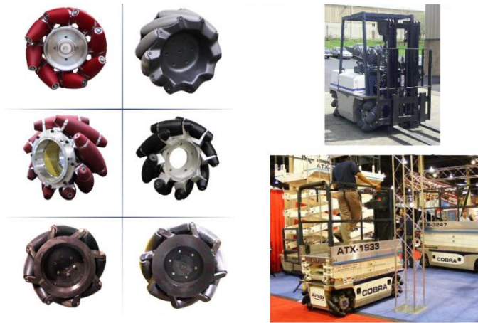
Figura 20. Modelos de ruedas mecanum usadas en sistemas de carga
