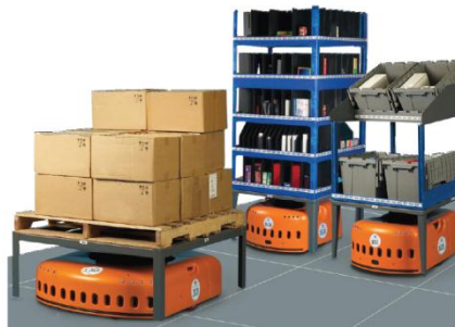
Figura 6: Robots del sistema KIVA y disposición de manejo de diferentes objetos dentro de una bodega
