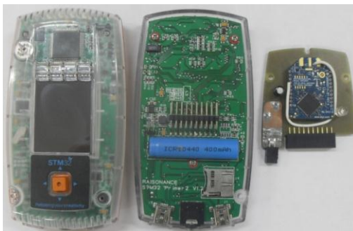
Figura 44 Módulo de control compuesto por un PRIMER 2 (vista frontal y posterior) y el módulo de comunicación inalámbrica.
