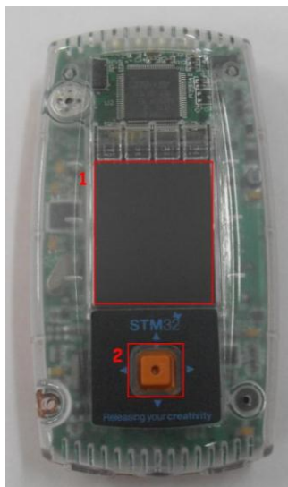
Figura 45 Periféricos empleados. Pantalla LCD como periférico de salida (1) y Joystick como periférico de entrada (2).
