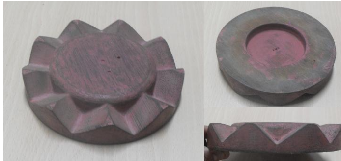
Figura 33. Vistas de los moldes obtenidos luego del proceso de mecanizado.
