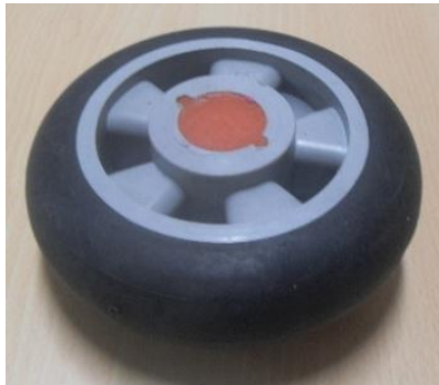
Figura 19. Rueda de goma con el soporte en acrílico fundido
