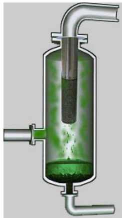
Figura 7. Esquema funcionamiento filtro coalescedor.
