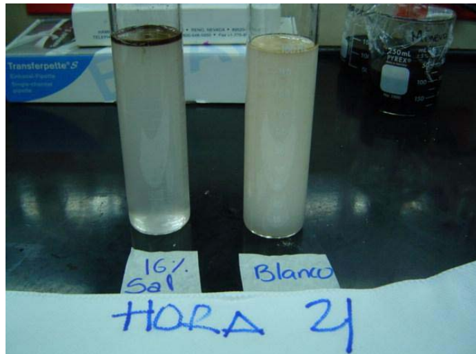
Figura 9. Pruebas laboratorio de reología y fenómenos Interfaciales ICP con cloruro de sodio a las 4 horas.
