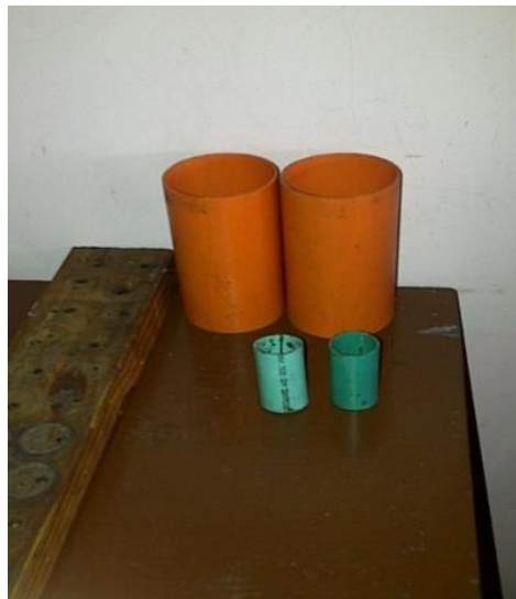
Figura 13. Moldes utilizados para construcción de probetas
