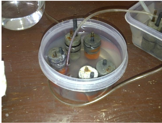
Figura 19. Probetas sumergidas en una solución de cloruro de sodio (NaCl) al 2% con oxígeno burbujeante. .
