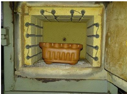
Figura 7. Caolín calentado a 700 °C para obtención de metacaolín
