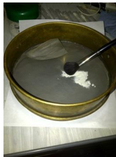
Figura 8. Preparación de muestras de caolín y metacaolín para análisis por difracción de Rayos X
