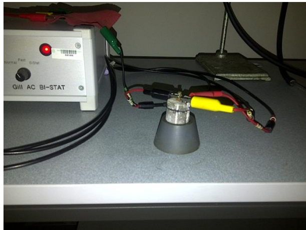
Figura 21. Probeta sometida al seguimiento de corrosión con EIS
