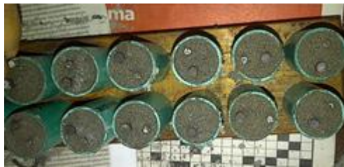
Figura 15. Construcción de probetas de concreto para fines eléctricos
