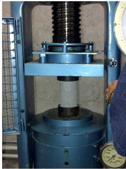
Figura 18. Prueba mecánica en la Maquina Universal de Ensayos
