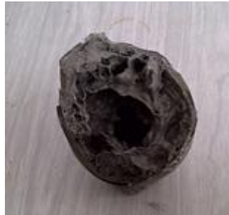
Figura 10. Geopolímero al finalizar la síntesis sin triturar
