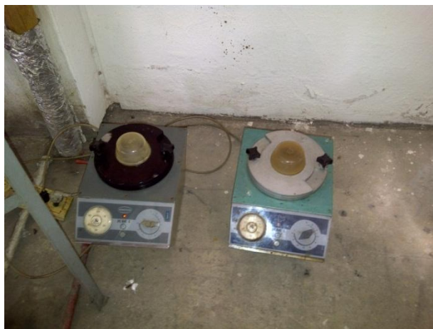
Figura 12. Macerado del geopolímero en morteros electrónicos de ágata
