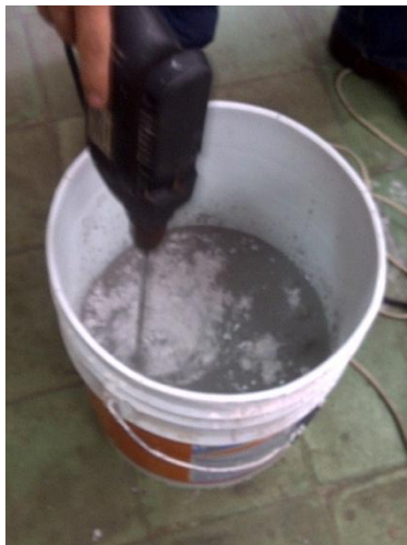
Figura 9. Mezcla de caolín, arena y silicato de sodio agitados mecánicamente
