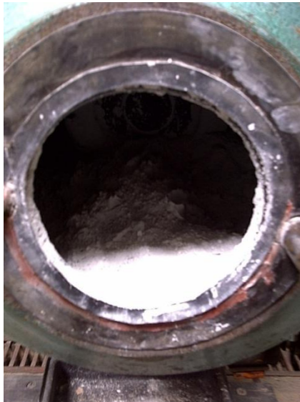
Figura 11. Molino de bolas y mezcla en trituración final
