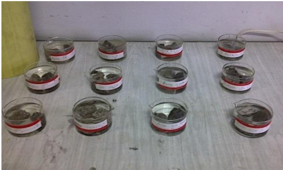
Figura 22. Sólidos de concreto sumergidos en soluciones de ácido, sulfato y base
