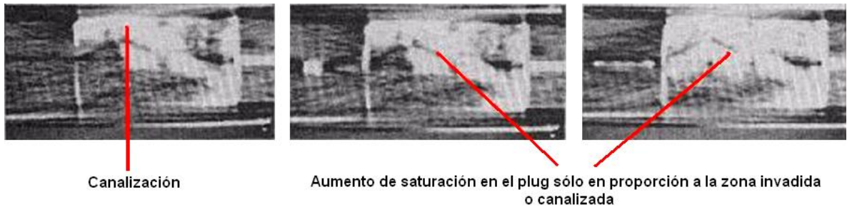
Figura 58. Avance de la canalización.
