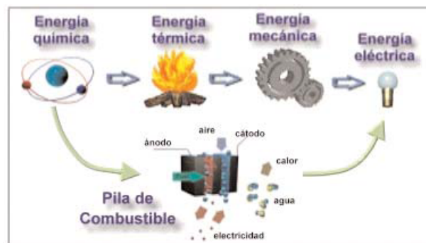
Figura 1.1: Transformación de la energía química en eléctrica por medio de procesos tradicionales y por medio de una celda de combustible. [1]
