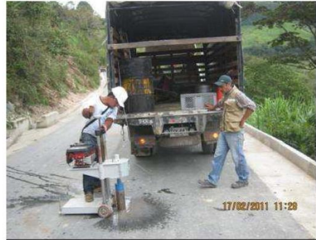
Foto No 8. Extracción de nucleos en el k13+890
